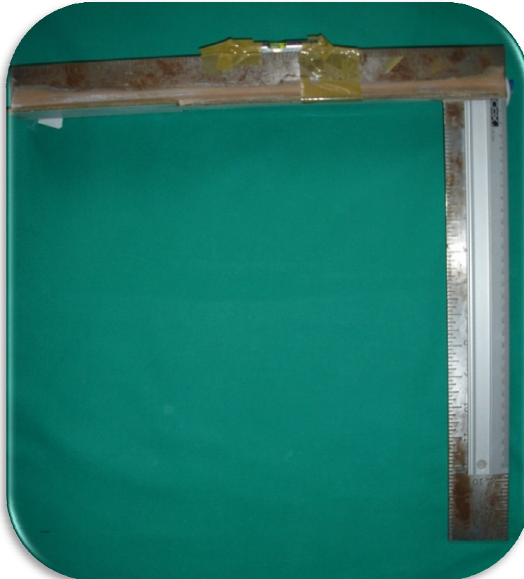
Foto 4: Calibrador doble deslizante con nivel
