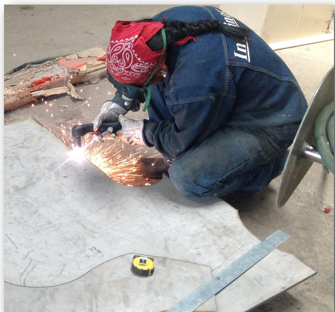
Fig 2. Trabajador usando corte por plasma manual
