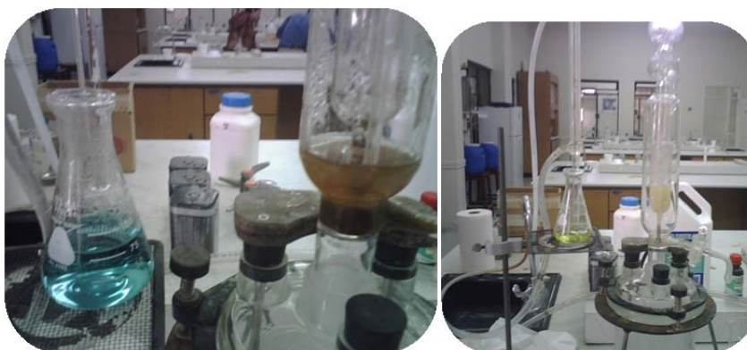
Figura N° 21. Destilación de las muestras en el equipo de Kjeldahl
