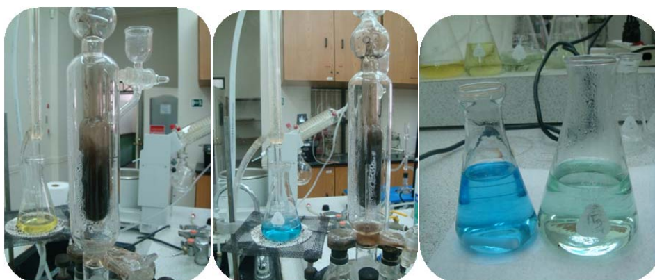
Figura N° 11. (a) y (b) Destilación de las muestras en el equipo de Kjeldahl. (c) Titulación con 0.5 M HCl de las muestras en el equipo de Kjeldahl
