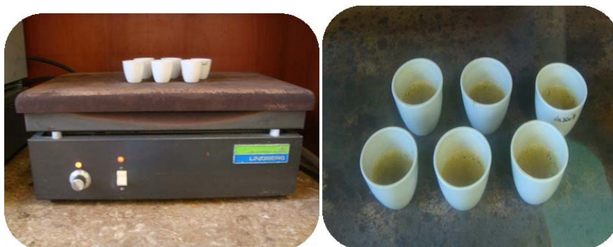
Figura N° 6. (a) Muestras en crisoles con agua regia en la manta de calentamiento
