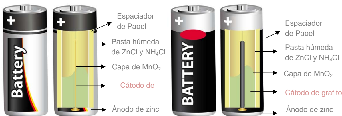
Figura N° 2. Partes de las pilas secas usadas o agotadas A y B. [30].
