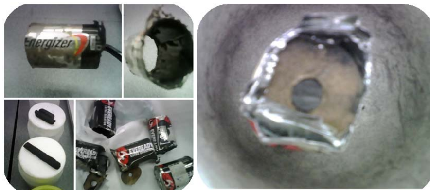
Figura N° 12. Pilas cortadas para extraer su contenido y barra de carbono de las pilas
