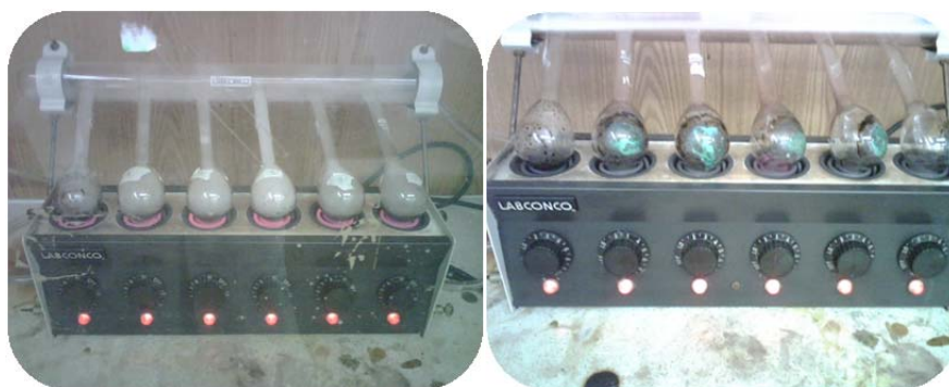
Figura N° 20. Digestión de las muestras en el equipo de Kjeldahl
