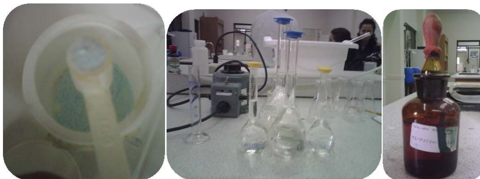
Figura N° 19. Materiales requeridos para el proceso de Kjeldahl
