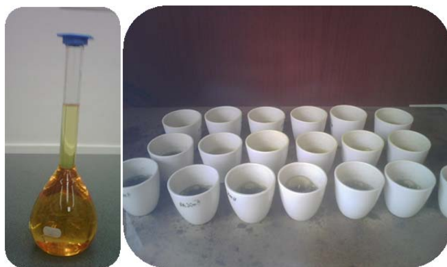
Figura N° 16. Balón con agua regia y crisoles con muestras calcinadas y agua regia.
