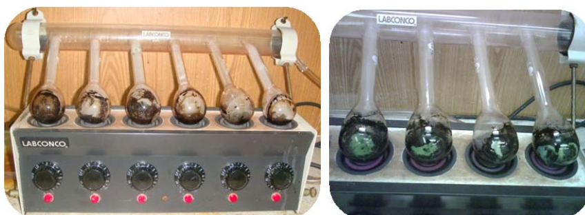
Figura N° 10. Digestión de las muestras en el equipo de Kjeldahl
