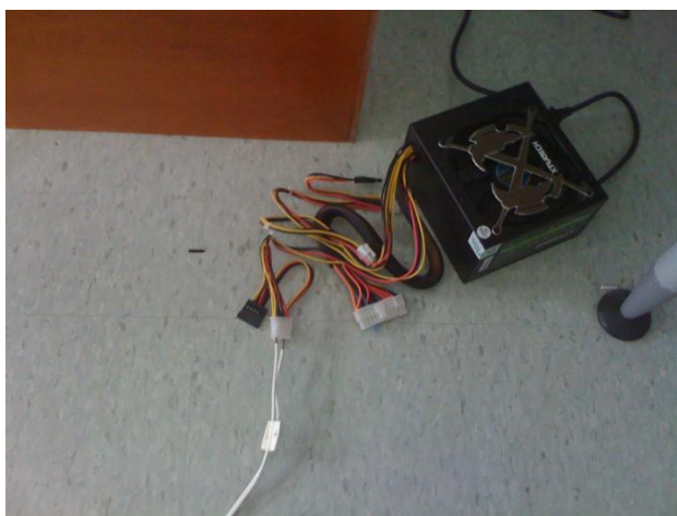
Figura 33: Conexión física de fuente de poder
