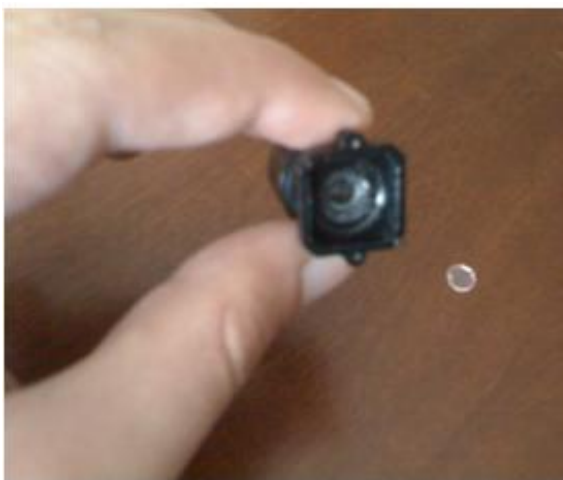
Figura 23: Filtro Infrarrojo removido del lente
