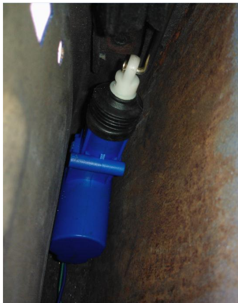
Figura 60. Servomotor instalado en la puerta del vehículo.
