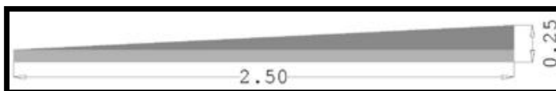
Andén con altura de 0.25 mt inclinación 10%
