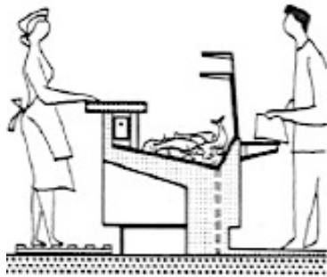
② Puesto de venta de pescado con instalación frigorífica y desagüe
