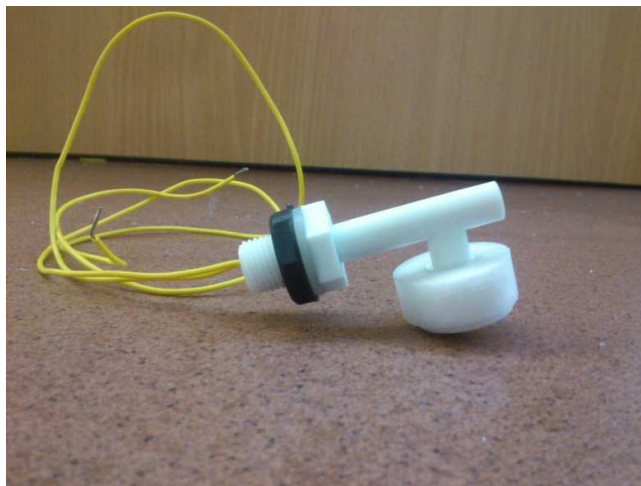
Figura 20. Sensor flotador de nivel tipo interruptor.
