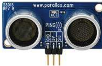
Figura 22. Sensor ultrasónico PING, ROBODACTA, 2011-2013.
