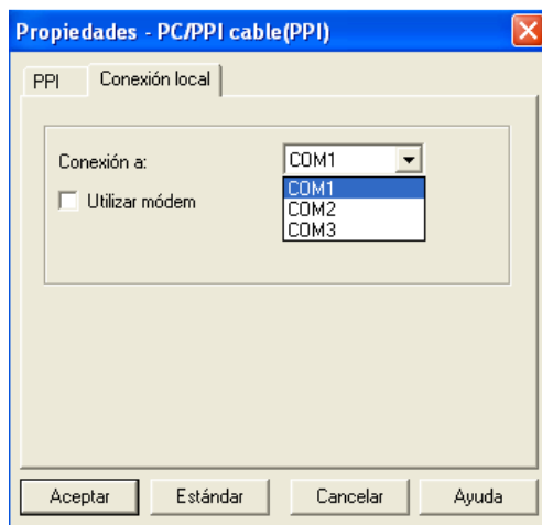
Figura 9. Configuración de parámetros de la conexión local
