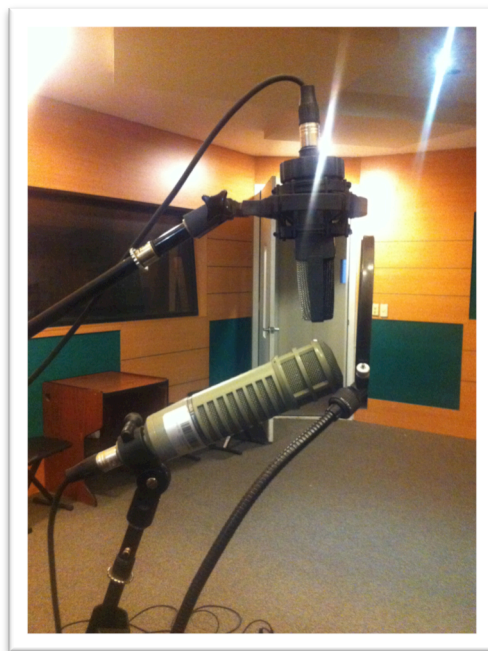
Figura 30. Posición de micrófonos para grabación de voces.
