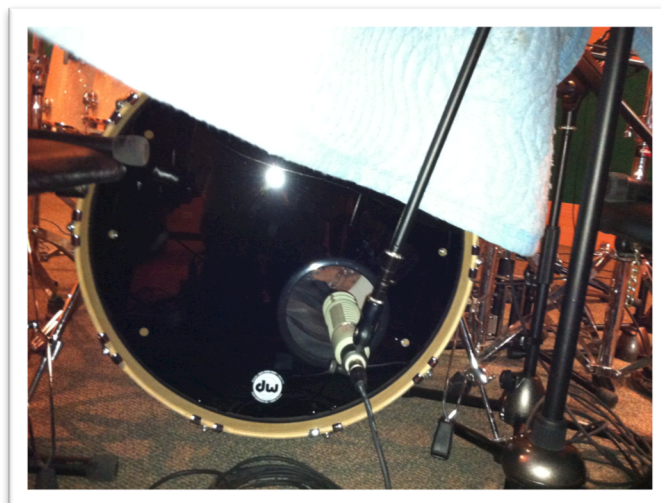
Figura 16. Posición de micrófono RE 20.
