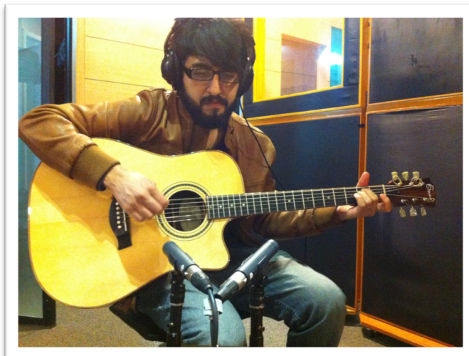
Figura 25. Posición de micrófonos para grabar guitarra acústica.
