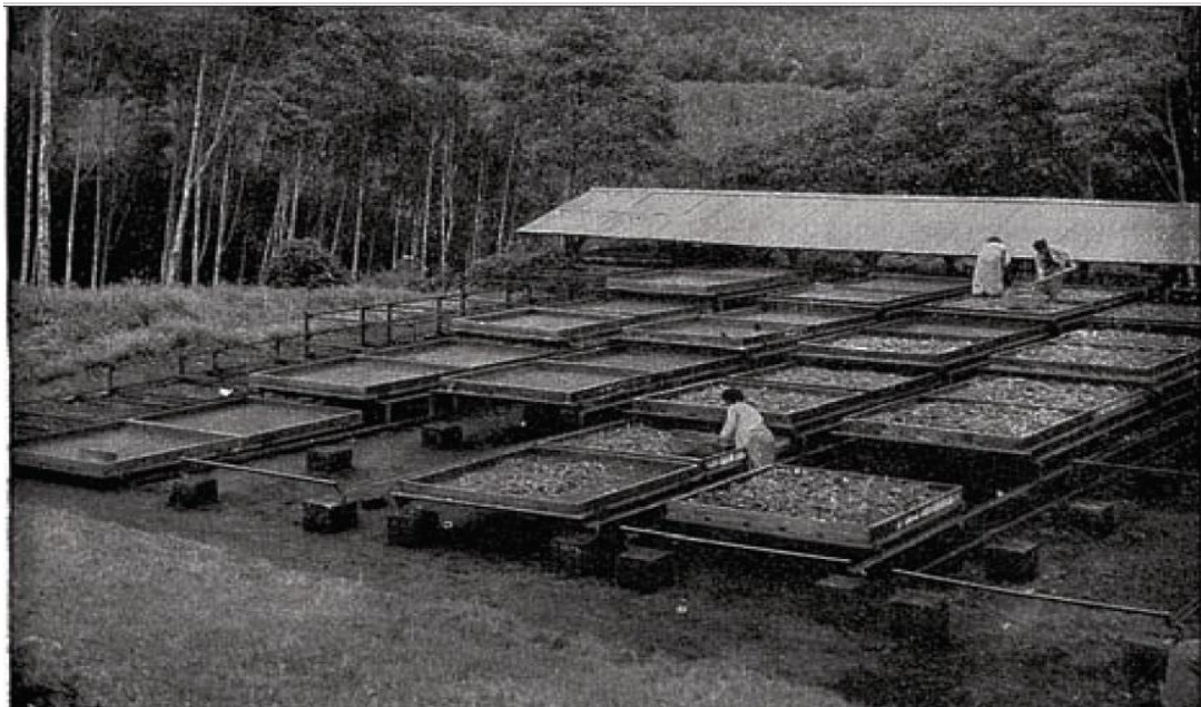
Imagen 22: Secadero de cascarilla en Java, con un sistema de cajones.
