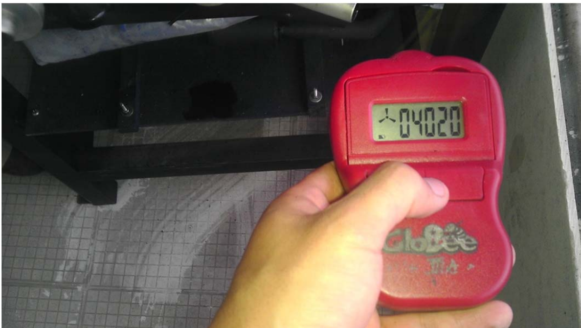
Figura 70. Calibración a 4020 revoluciones por minuto.
