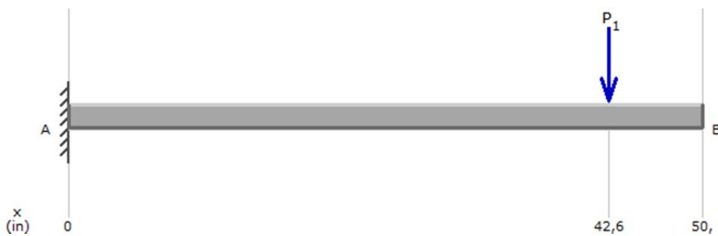
Figura 36. Diagrama de carga aplicada a la cola vertical.
