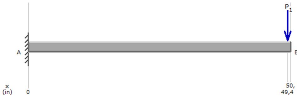
Figura 33. Diagrama de carga aplicada a la cola horizontal.
