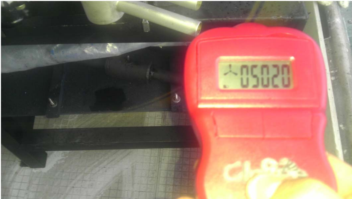
Figura 68. Uso de tacómetro para calibrar las RPM.
