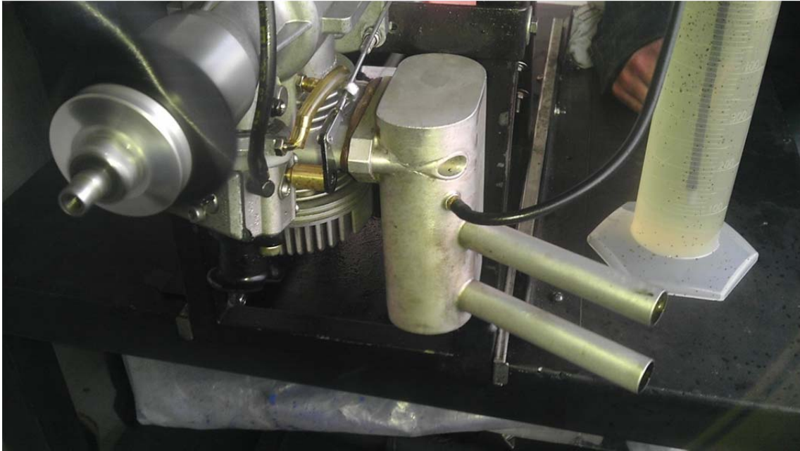
Figura 69. Vista del motor andando con su probeta de consumo de combustible.
