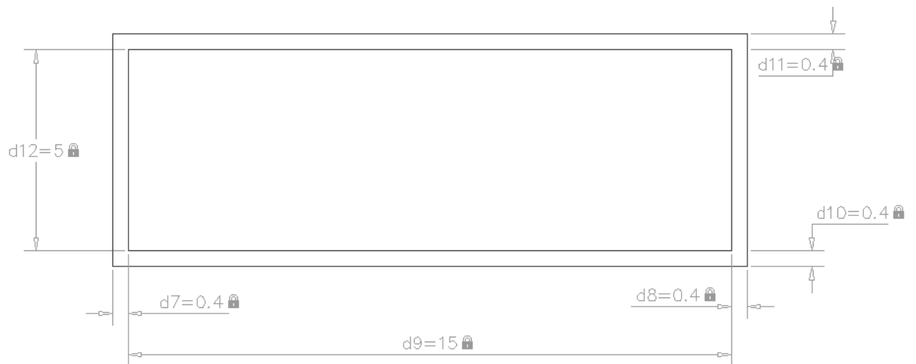
Figura 6. Vista de Planta de la Cisterna.
