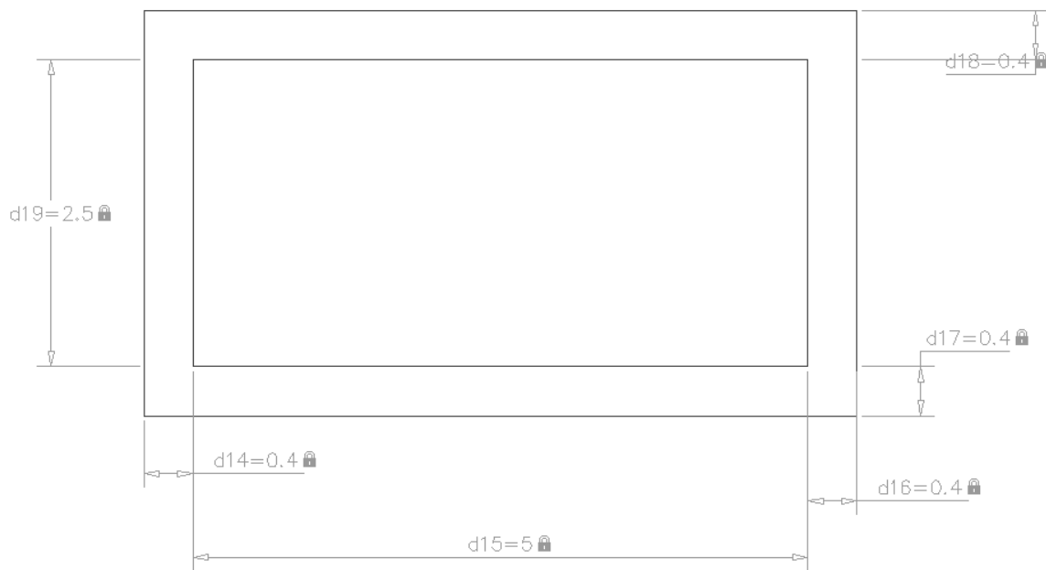
Figura 5. Vista Lateral de la Cisterna.
