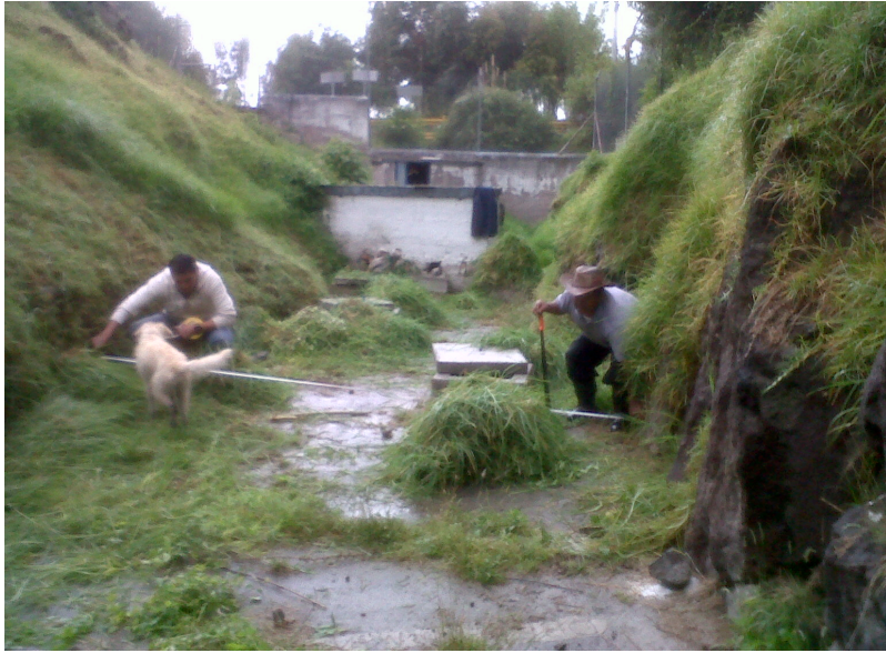
Figura 9. Medición del volumen de agua del tanque de reserva.
