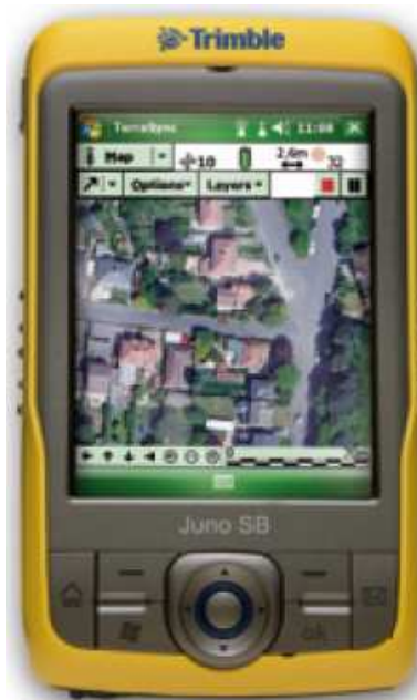
Fig. 2.11 Dispositivo móvil (GPS) para colección de datos
