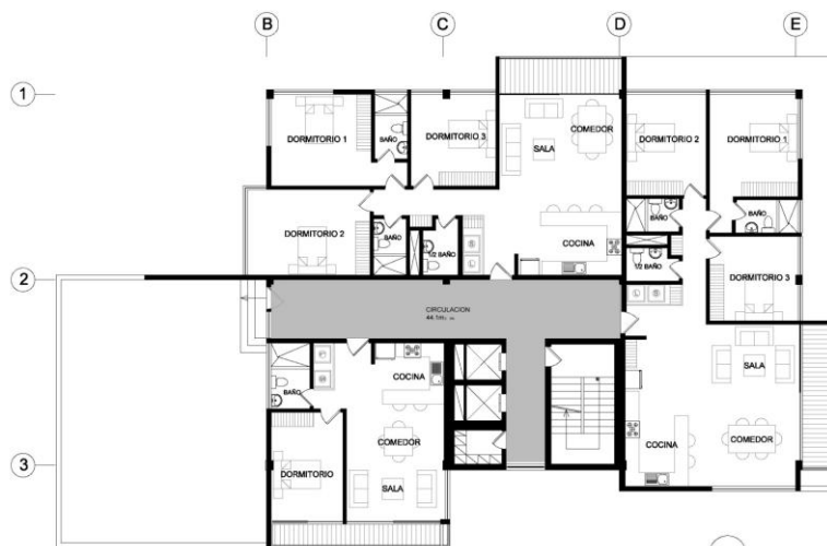
EDIFICIO A (488.6m 2 ) PISOS 6-8 1/200
