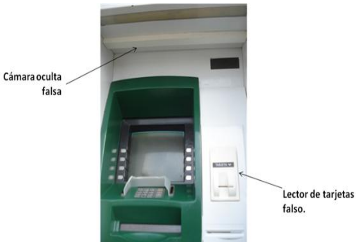
Ilustración 23: ATM con cámara oculta y lector de tarjetas falso
