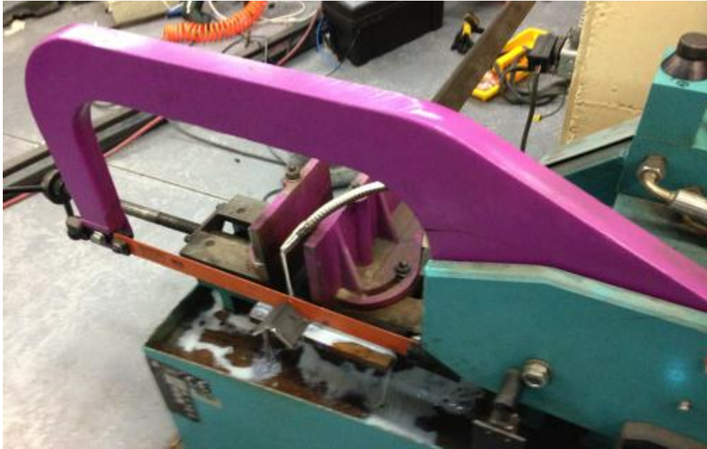
Figura 32.- Corte de perfiles para soportes de la estructura.
