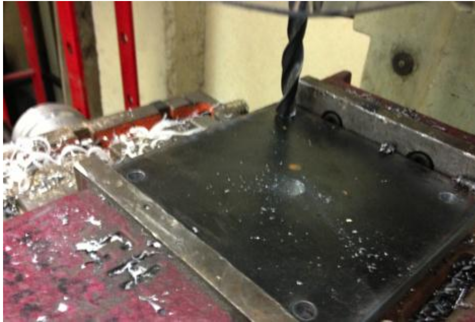
Figura 38.- Perforación con la fresadora de las placas sujetadoras del cilindro.
