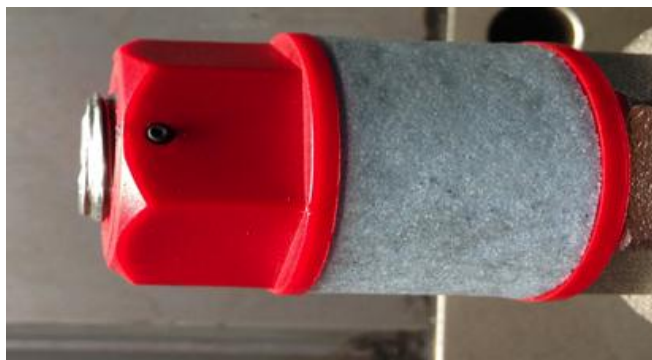
Figura 50.- Posición 4: Posición final del Silenciador Regulador de Flujo (una vuelta completa)
