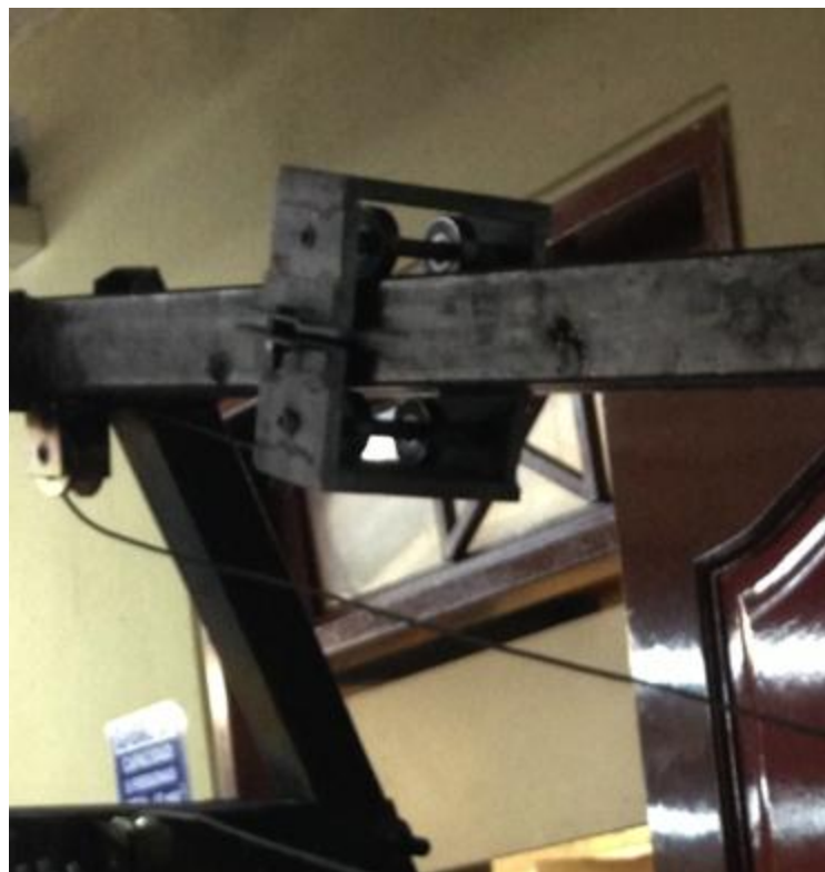
Figura 39.- Carro rediseñado para utilizar en las pruebas.
