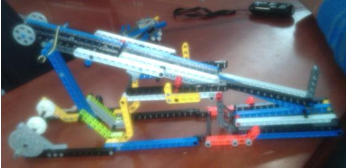
Figura 3.- Prototipo a escala de la plataforma del sistema de lanzamiento construida con legos.
