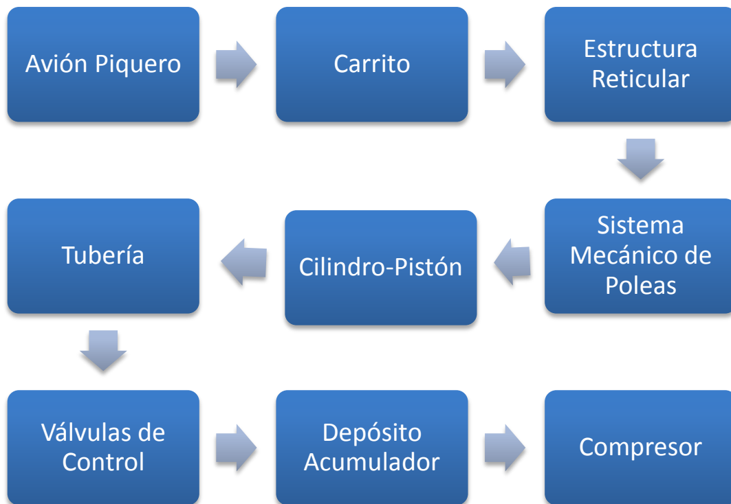
Figura 7.- Diagrama de los componentes principales del sistema de lanzamiento.
