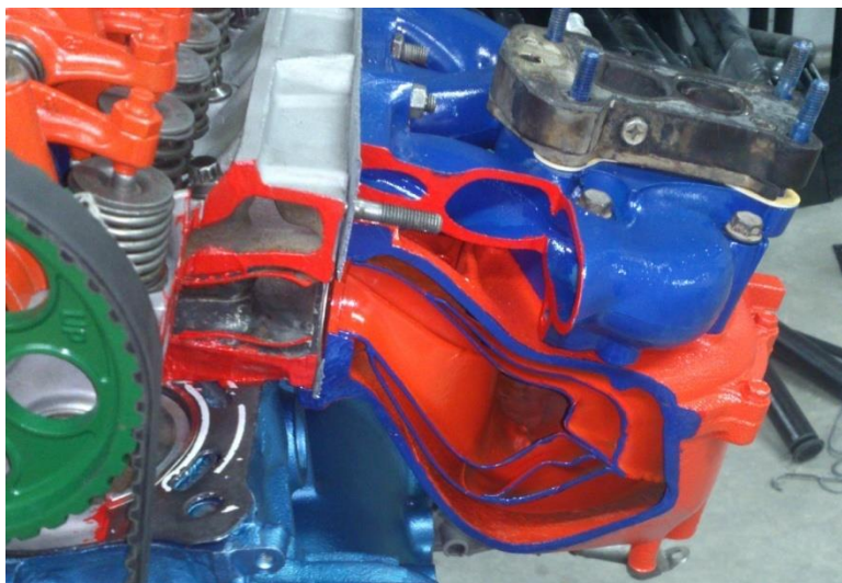
Foto 38: Armado de colectores de admisión y escape.
