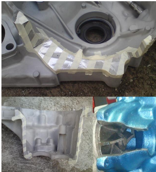
Foto 19: Cortes realizados por medio de disco de corte.
