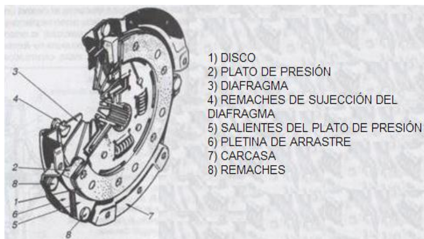
Imagen 49: Prensa de embrague de diafragma seccionada. 54
