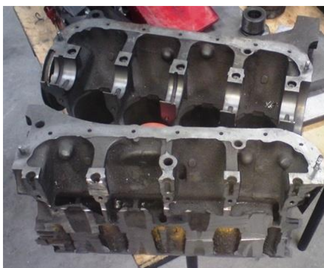
Foto 20: Corte realizado por medio de sierra de cinta.
