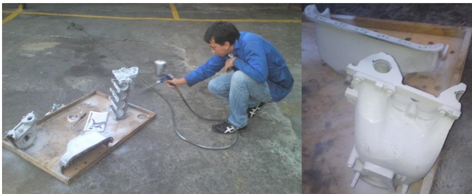
Foto 25: Aplicación de fondo para pintura automotriz.
