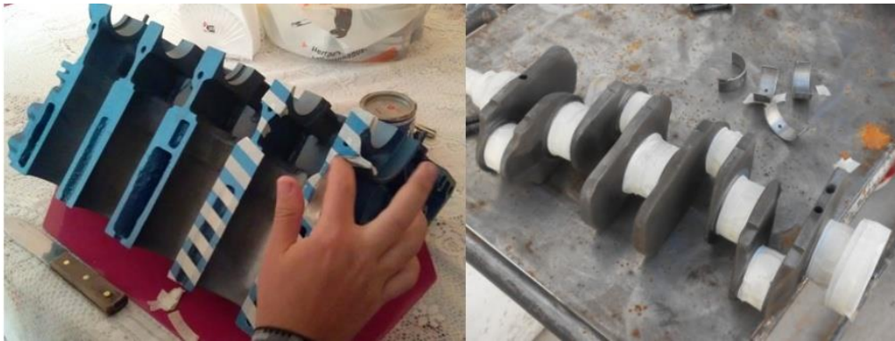
Foto 24: Cubrimiento de zonas donde no se aplica pintura.
