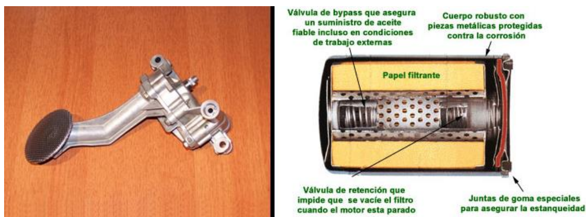
Imagen 43: Filtros de aceite A- Colador; B.- Filtro principal 48
