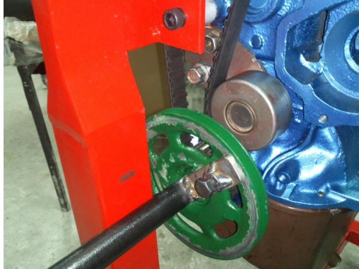
Foto 29: Adaptación de manivela en polea del cigüeñal.
