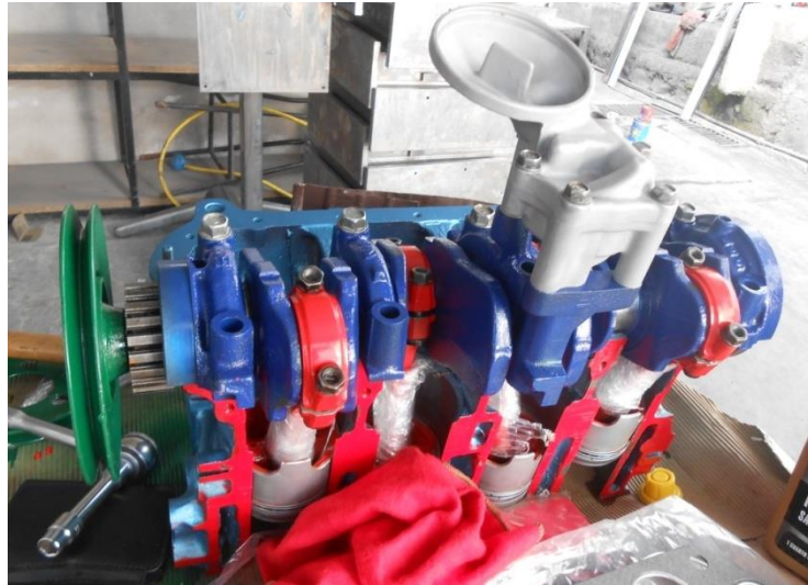
Foto 31: Polea y piñón de transmisión. Bomba de aceite.
