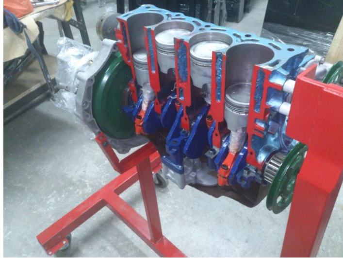
Foto 34: Bloque en conjunto con caja de cambios y embrague en soporte.
