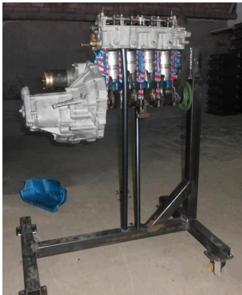
Foto 28: Comprobación inicial de soporte para motor.
