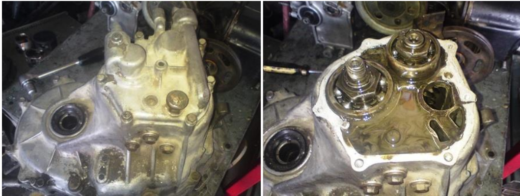
Foto 17: Zonas para corte en la carcasa de la caja de cambios.
