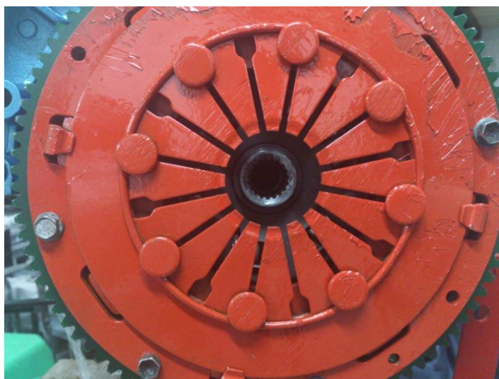
Foto 33: Componentes del embrague alineados al volante.
