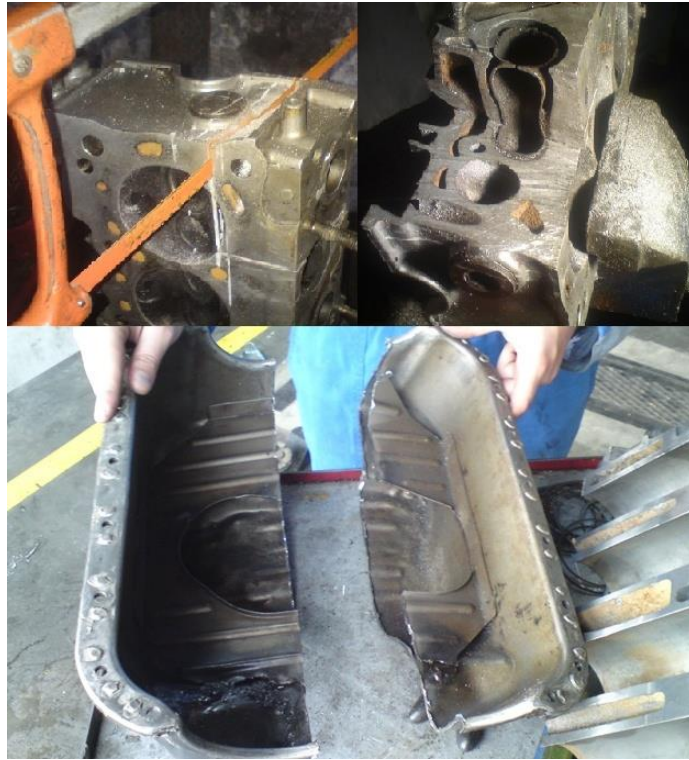
Foto 18: Cortes realizados por medio de sierra de mano.
