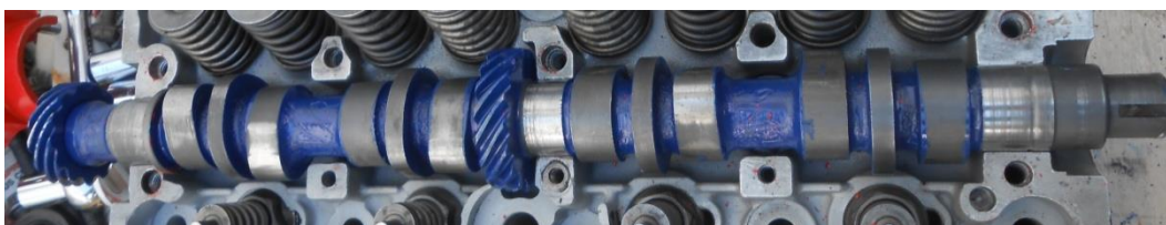
Foto 6: Árbol de levas ubicado en sus puntos de apoyo de la culata.
