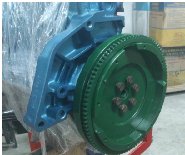
Foto 32: Bloque motor en soporte con volante de masa
