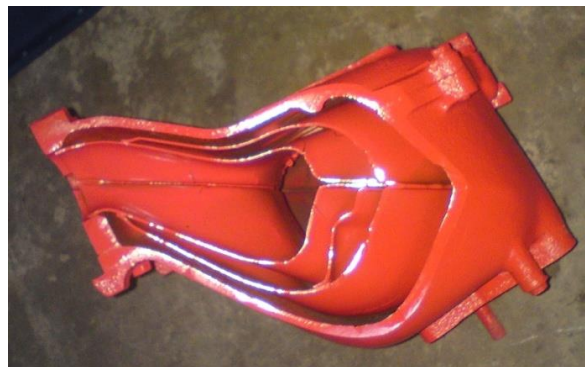
Foto 8: Colector de Escape
