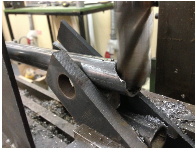
Figura 29: Desbaste de acoplamiento tubo-tubo de aproximación vertical
