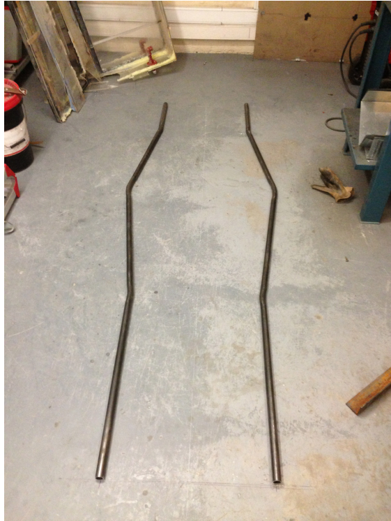
Figura 32: Vigas paralelas base de chasis
