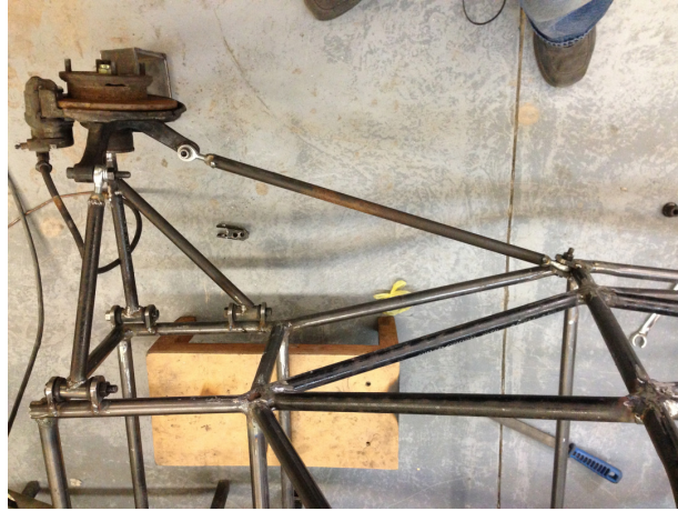
Figura 43: Mesa trasera Vista superior con todos sus miembros
