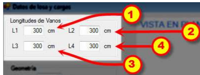
Figura 58 .- Partes de la entrada de datos de longitudes de vanos de la losa
