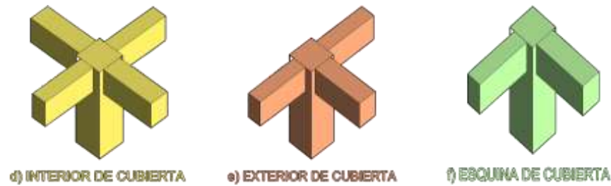
Figura 7.- Clasificación de conexiones viga-columna de cubierta
