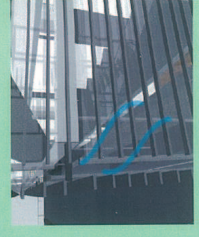
Fujo transversal del aire a través de las pieles
