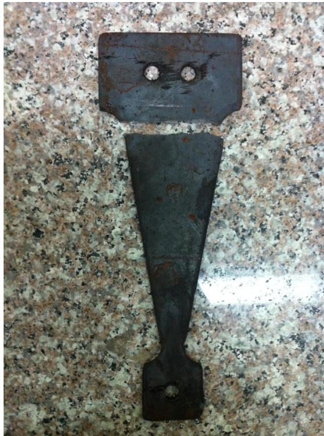
Figura 58: Resultado de la tercera probeta al análisis de fatiga a 13mm de deflexión
