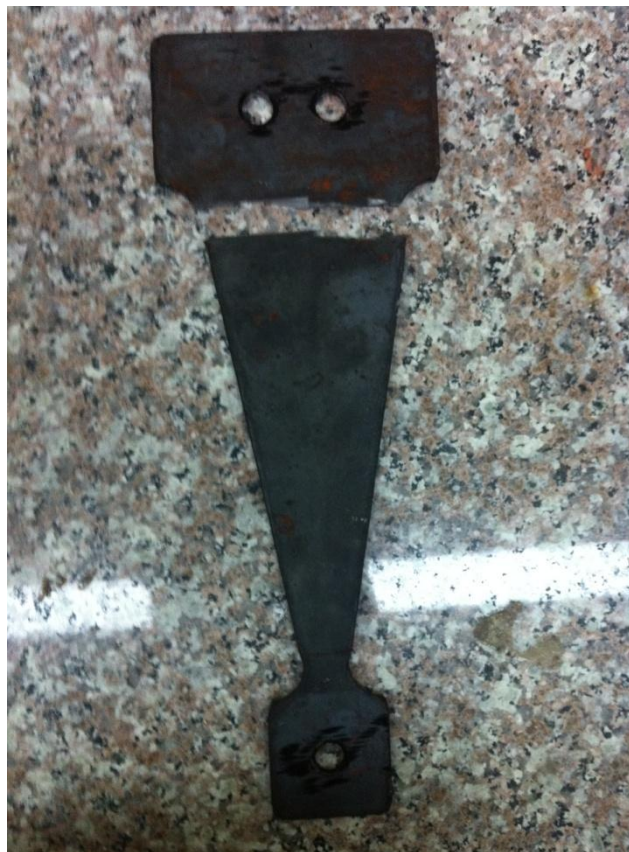
Figura 64: Resultado de la cuarta probeta al análisis de fatiga a 9mm de deflexión
