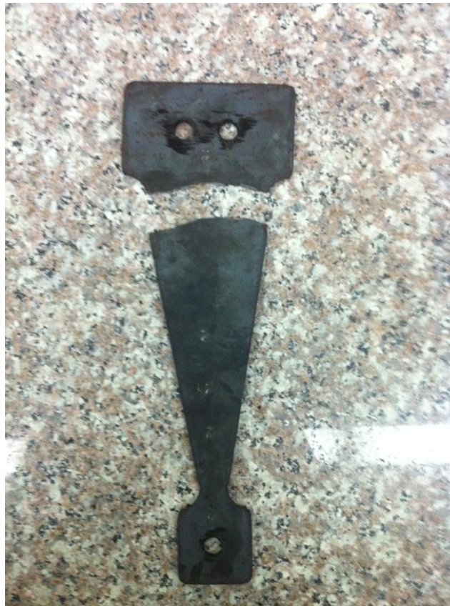
Figura 57: Resultado de la segunda probeta al análisis de fatiga a 13mm de deflexión
