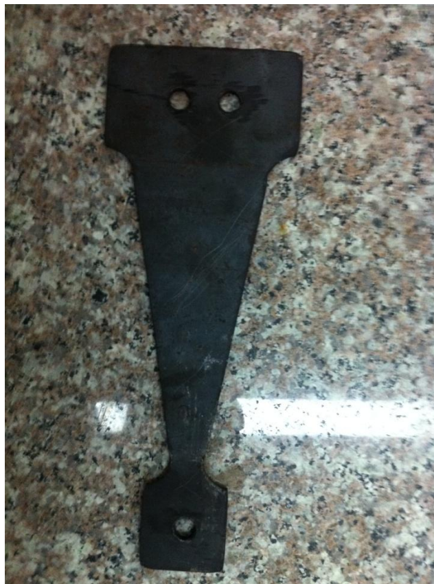
Figura 54: Probeta Modelo para pruebas de fatiga por flexión.
