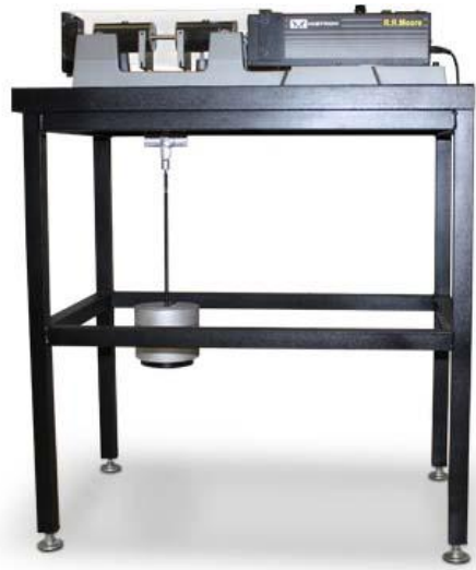
Figura 2: Máquina prueba de fatiga por flexión rotativa (R.R. Moore Rotating Beam Fatigue Testing System)
