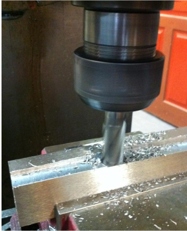
Figura 40: Fresadora devastando con fresa
