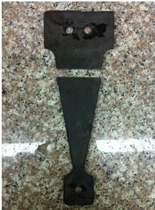
Figura 62: Resultado de la primera probeta al análisis de fatiga a 9mm de deflexión
