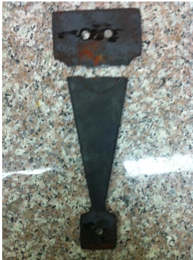
Figura 63: Resultado de la tercera probeta al análisis de fatiga a 9mm de deflexión
