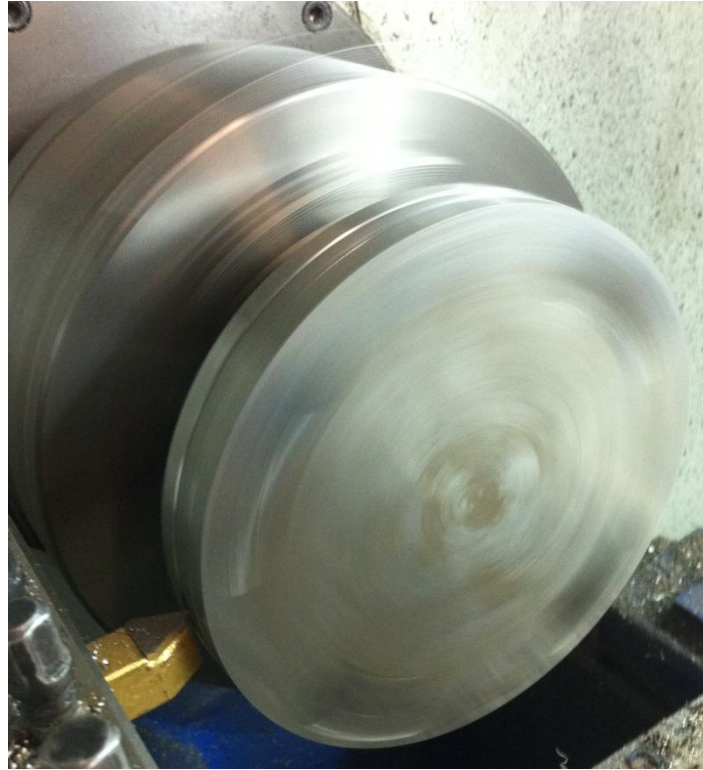
Figura 43: Torno igualando disco excéntrico
