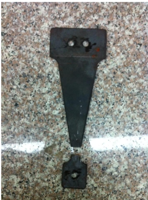
Figura 61: Resultado de la primera probeta al análisis de fatiga a 9mm de deflexión
