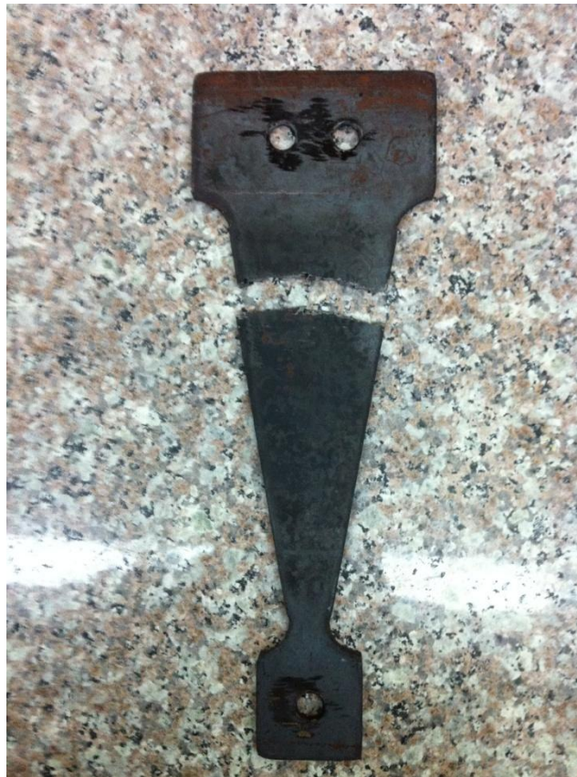
Figura 59: Resultado de la cuarta probeta al análisis de fatiga a 13mm de deflexión
