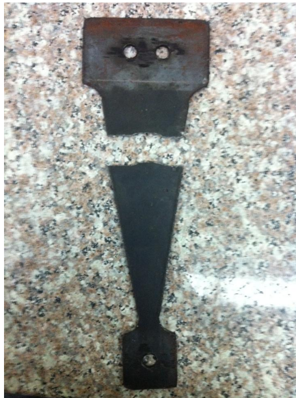
Figura 56: Resultado de la primera probeta al análisis de fatiga a 13mm de deflexión
