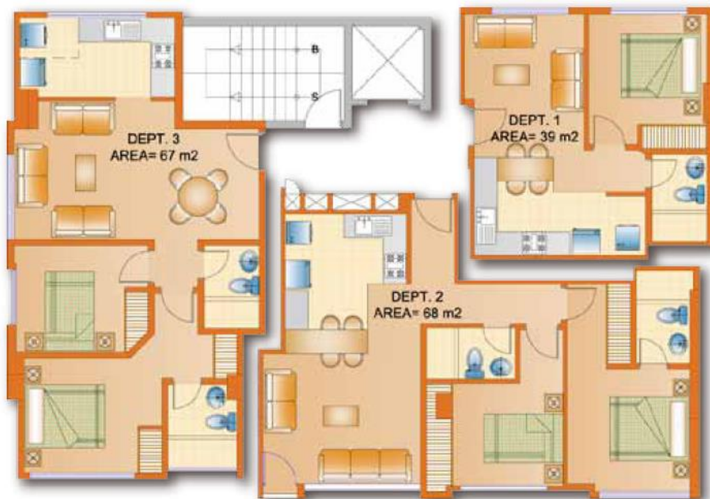
Ilustración 28. Distribución Arquitectónica Planta Tipo (Pisos 2 al 4). Fuente: Tecniurban. Cía. Ltda. Elaborado por: Arq. Sebastián Valdivieso.
