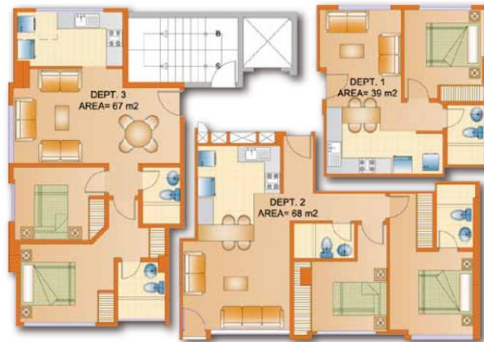
Ilustración 3. Distribución Arquitectónica Planta Tipo (Pisos 2 al 4)
