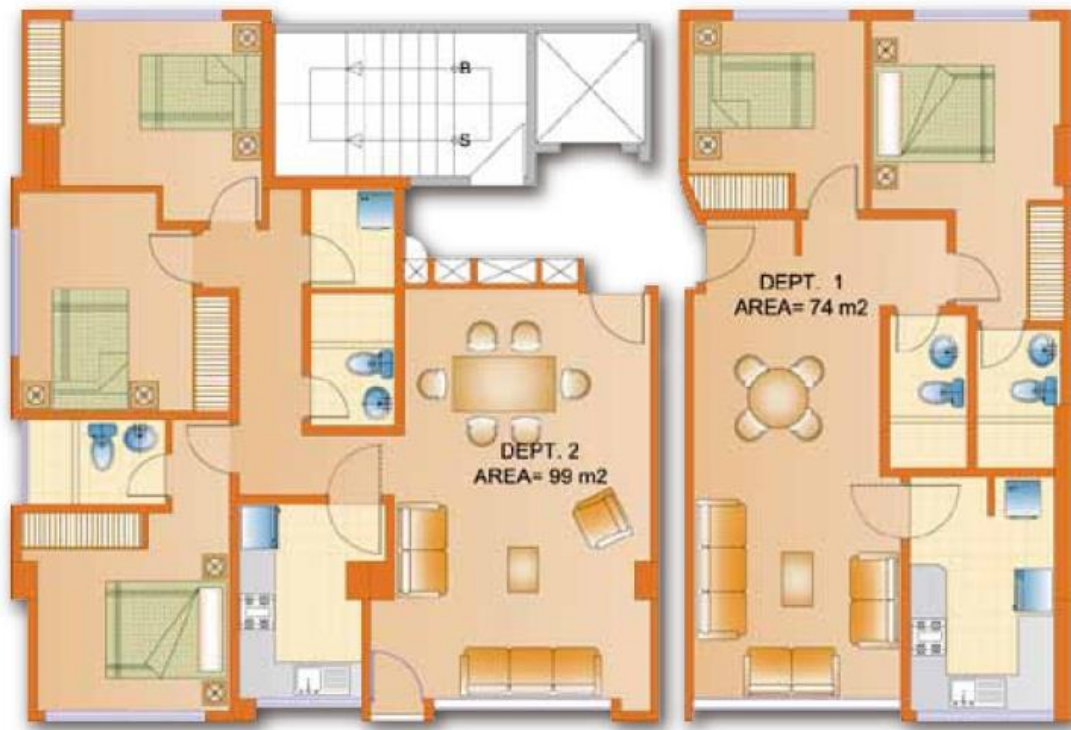
Ilustración 29. Distribución Arquitectónica Planta 5ta y 6ta. Fuente: Tecniurban. Cía. Ltda. Elaborado por: Arq. Sebastián Valdivieso.
