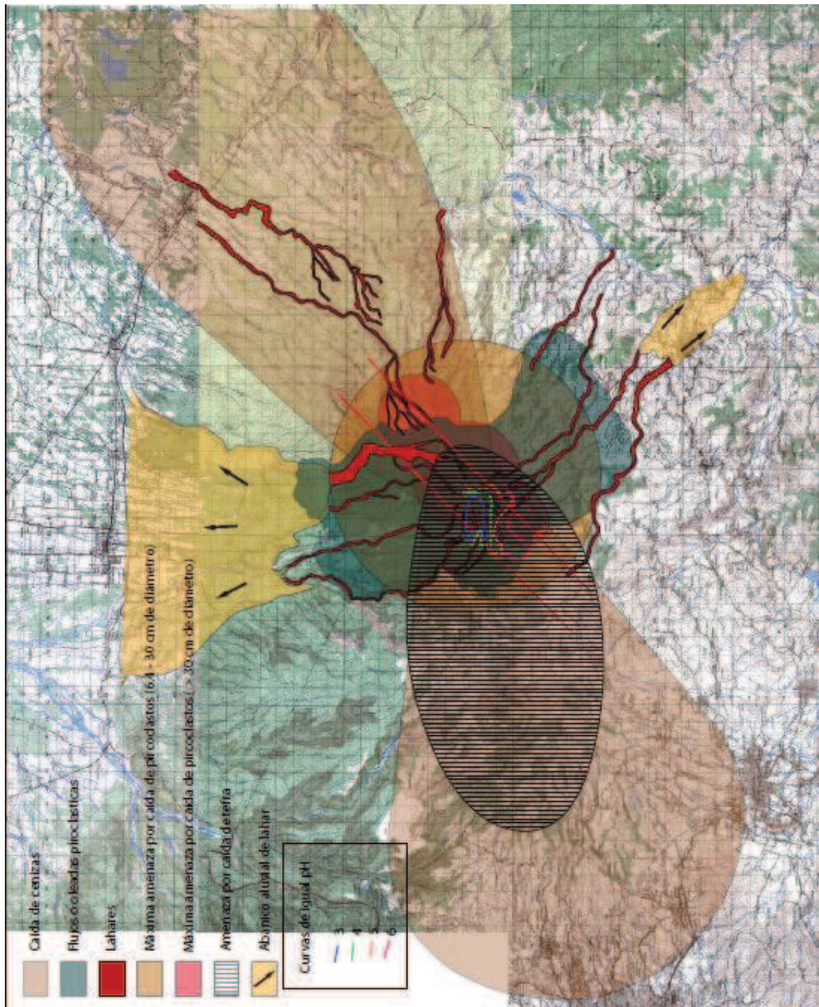
Figura 89: Síntesis de mapas de peligros volcánicos del Turrialba, a la misma escala, que incluye los de Paniagua & Soto, 1986; Jerez & Cline, 1990; Soto & Alvarado, 2008, con sus diferentes posibles escenarios, con el fin de adecuar los criterios, de manera geológica y con base en ellos, proceder a escenarios determinísticos.
