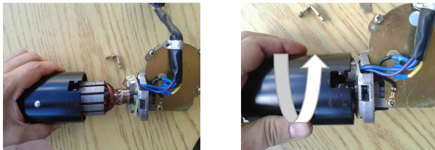
Figura 50: Modificación en velocidad de giro del motor
