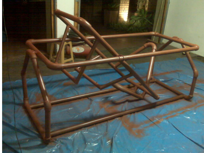
Figura 11: Simulador de 2DOF con tubos de plástico 19
