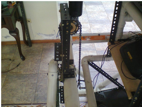
Figura 52: Montaje motor vertical
