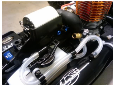
Figura 20: Tanque de combustible
