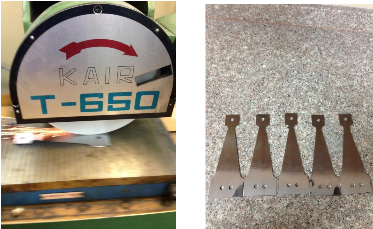
Figura 16: Pulido y rectificado de probeta estándar
