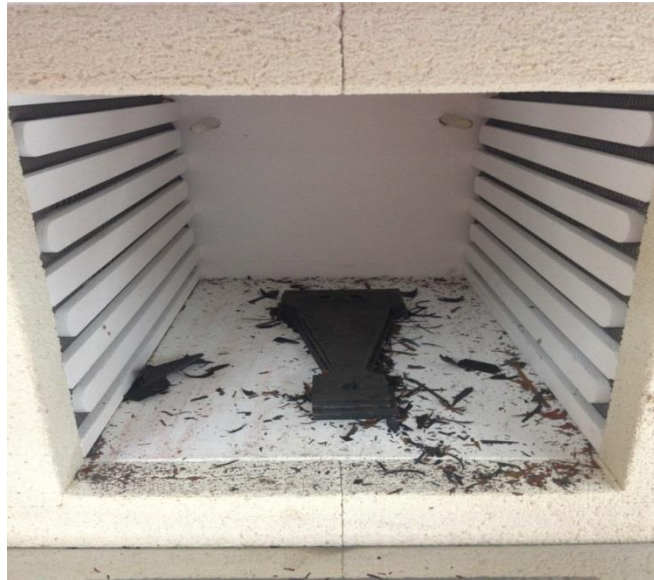
Figura 17: Probeta estándar finalizado el recocido
