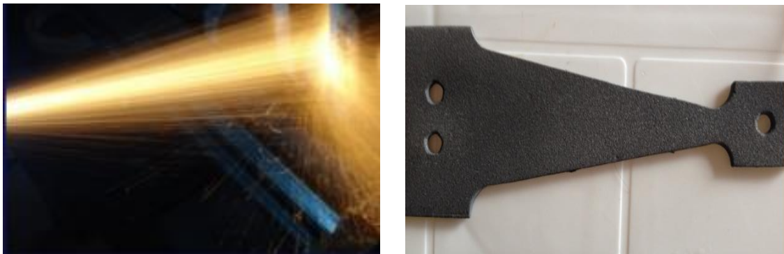
Figura 19: Proceso de termorociado recubrimiento de probetas
