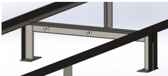
Ilustración 47: Diseño Paramétrico Anclaje Medio Riel
