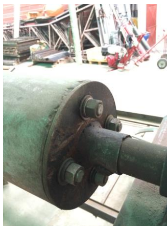
Ilustración 29: Detalle Real Acople Punta
