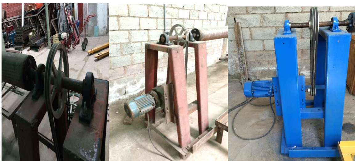
Ilustración 33: Diseño Real Soporte Motorizado del Mandril
