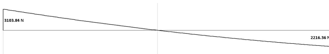
Ilustración 14: Diagrama de Cortante Mandril
