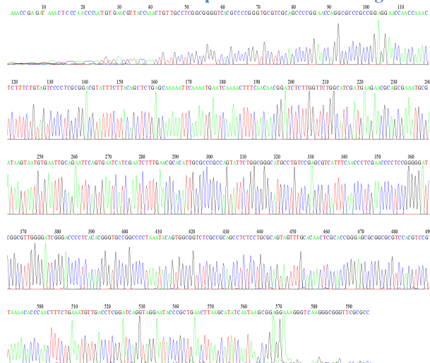
Figura 11. Visualización de picos de buena calidad identificados por la intensidad media de cada fila de nucleótidos definidos por el método de Sanger. Este gráfico representa una buena lectura.
