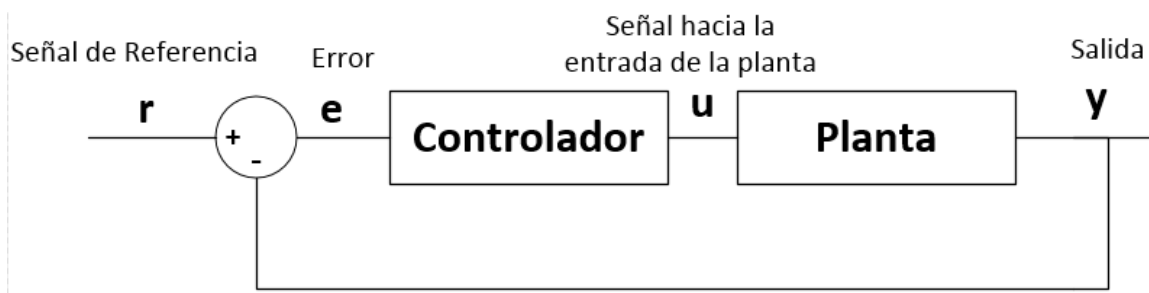
Figura 12.- Esquema básico de un sistema de control en lazo cerrado.
