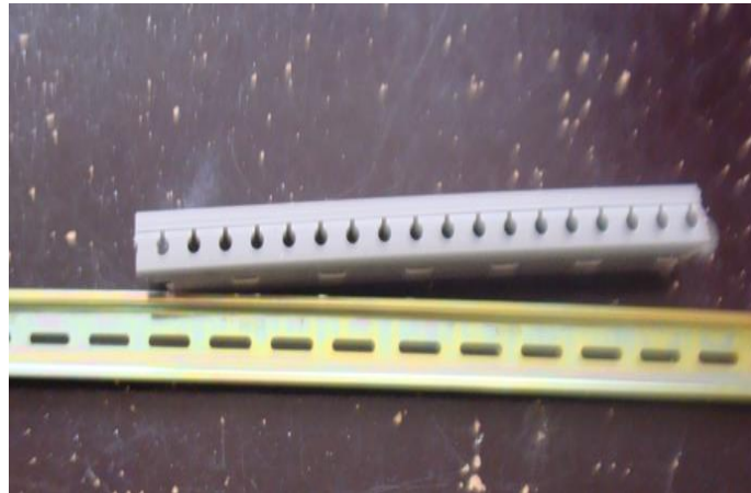
Figura 11 Canaleta y Riel Metálico.
