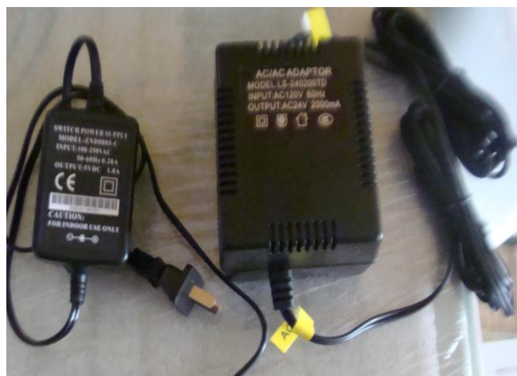
Figura 13 Transformador para cámara de video vigilancia y conversor de medios.
