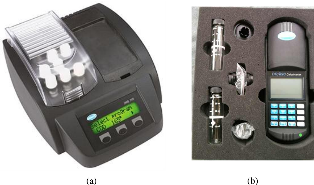
Figura 3.5 a) Reactor HACH DRB 200, b) Colorímetro HACH DR/890
