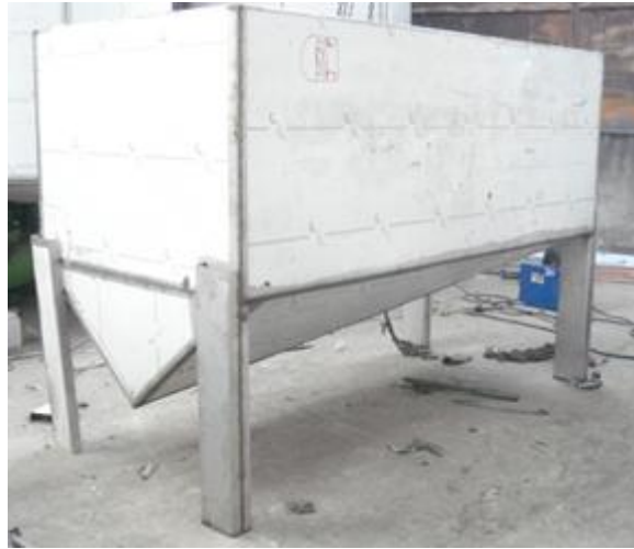
Figura 5.2 Tanque de almacenamiento de estiércol
