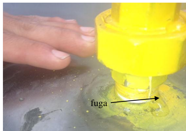
Figura 6.7 Fuga en la tapa del filtro
