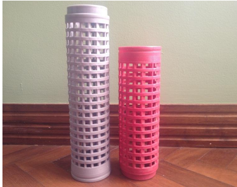
Figura 5.9 Relleno para el biodigestor
