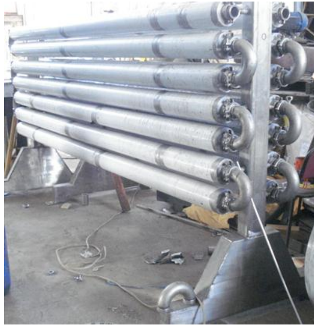
Figura 5.14 Intercambiador de calor tubo en carcasa U-3
