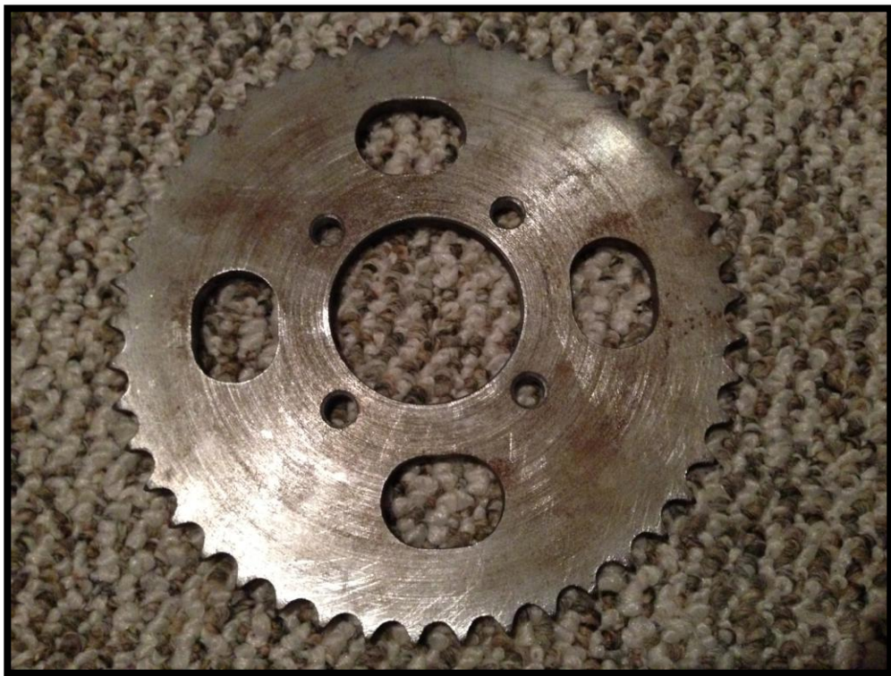
Figura 36. Catalina maquinada con una fresadora sin control automático.
