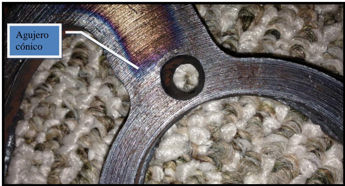
Figura 33. Corte de catalina con plasma CNC evidenciando agujeros cónicos e irregulares.
