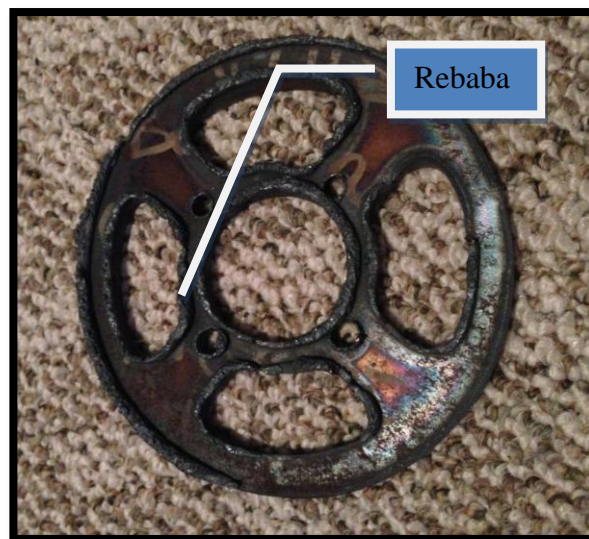
Figura 32. Catalina cortada con plasma CNC evidenciando la rebaba.
