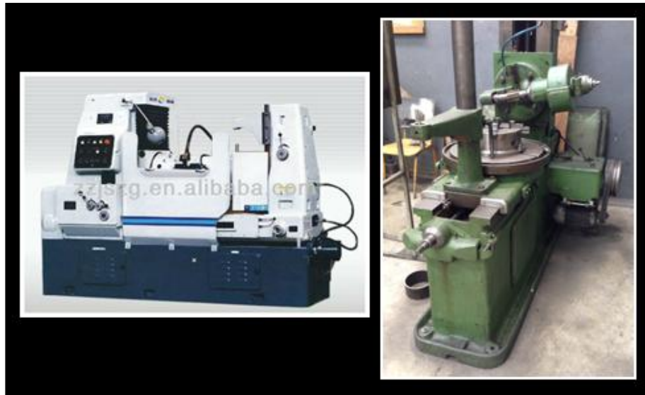
Figura 16. A la izquierda la máquina talladora de engranajes con fresa madre CNC (Zhengzhou Jiesheng Heavy Machinery Manufacturing Co., Ltd, 2014) y a la derecha la talladora mecánica propiedad de TESP (Centro de Formación Artesanal Fiscomisional, Quito-Ecuador).
