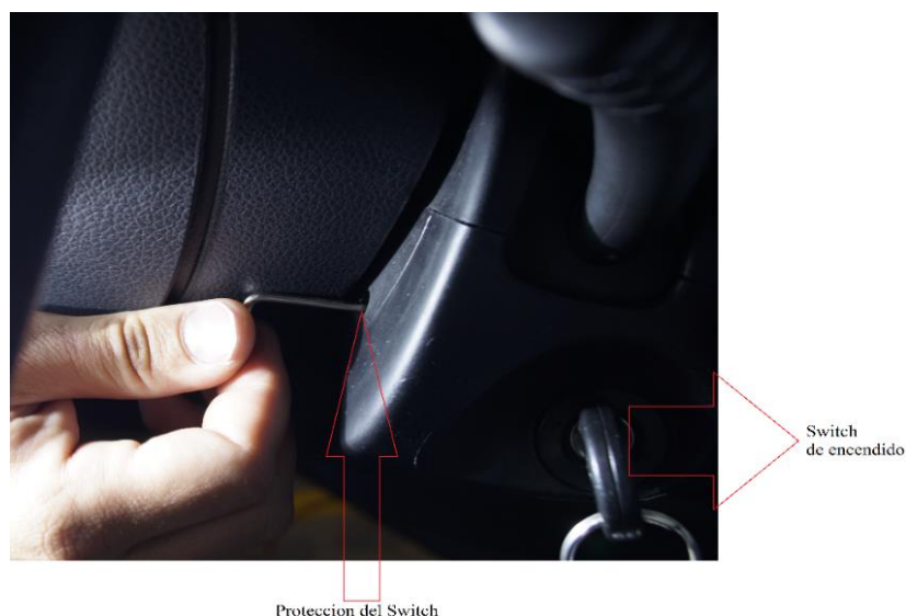
Ilustración 5.4: Cuarto procedimiento de montaje.
