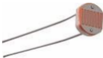
Figura 3.16: Resistencias Dependientes de la Luz.
