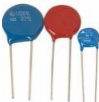
Figura 3.17: Resistencias Dependientes de la Tensión.
