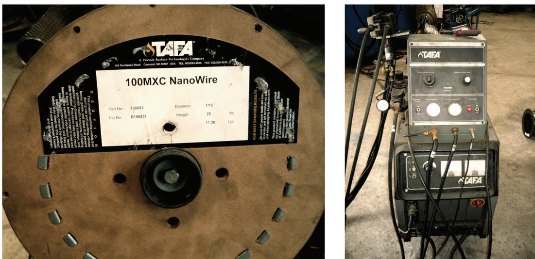
Figura 4.10: Material de Recubrimiento y Equipo de TR.
