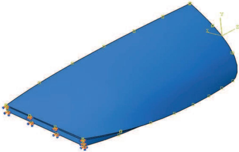
Figura 4.49: Condiciones de borde modelamiento álabes.
