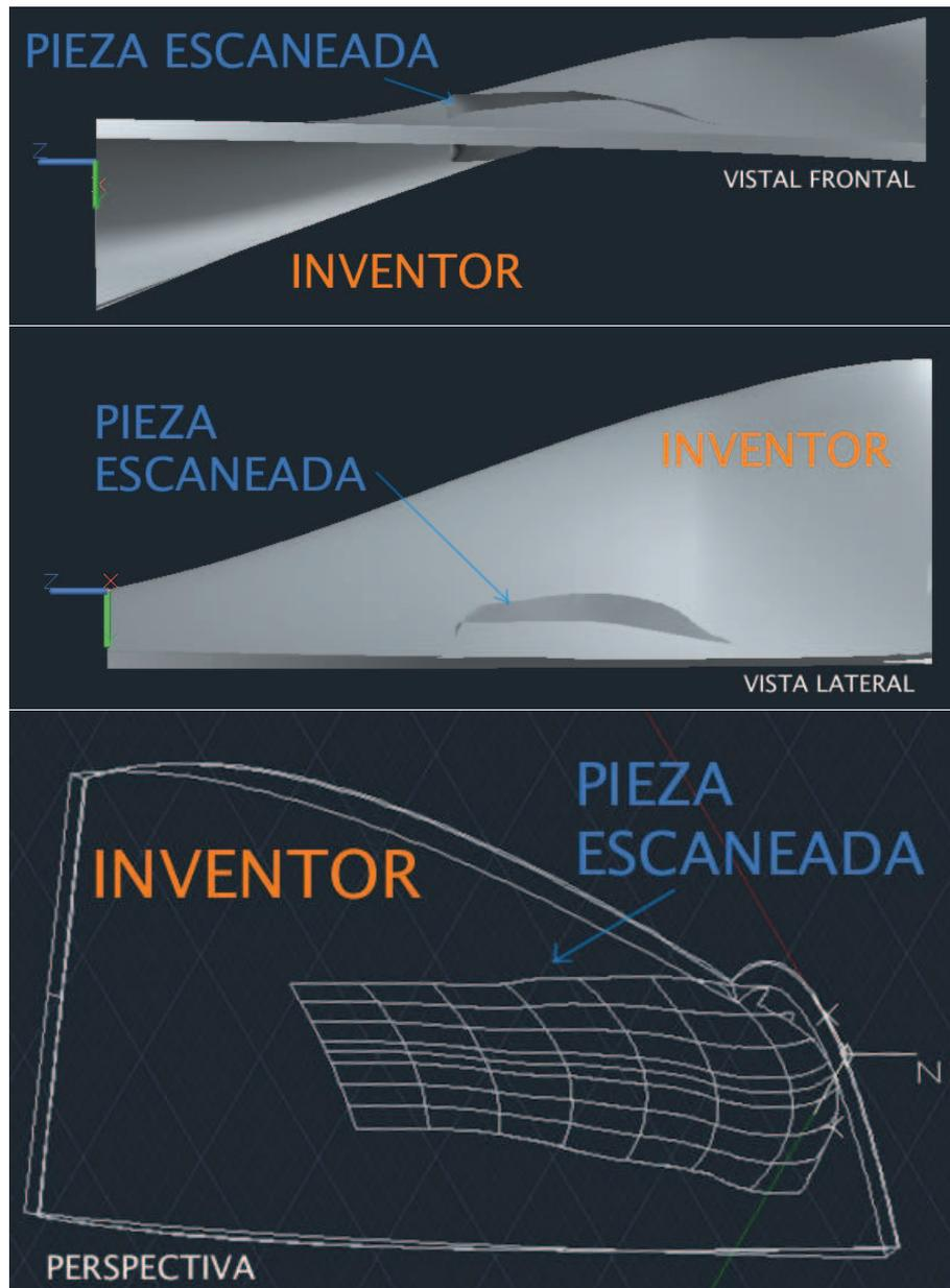
Figura 4.48: Modelo Tridimensional de la Pieza en forma de álabe hecho en INVENTOR vs. la pieza escaneada.
