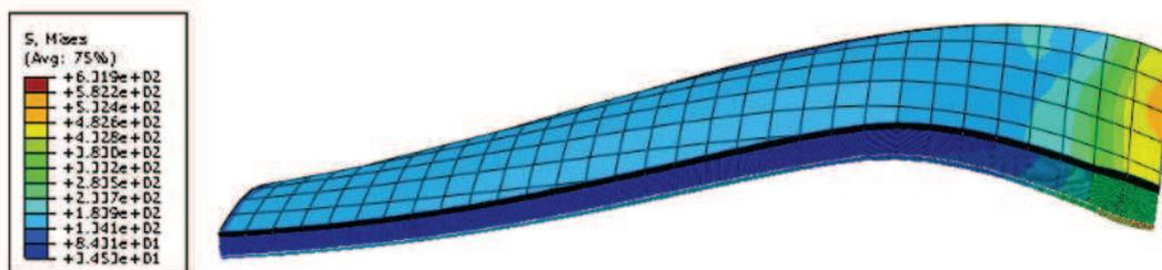
Figura 4.62: Distribución de esfuerzos de Von Mises (Corte Lateral) en la Probeta P-3D recubierta en ambas caras con alambre 100MXC sobre un sustrato de Aluminio.
