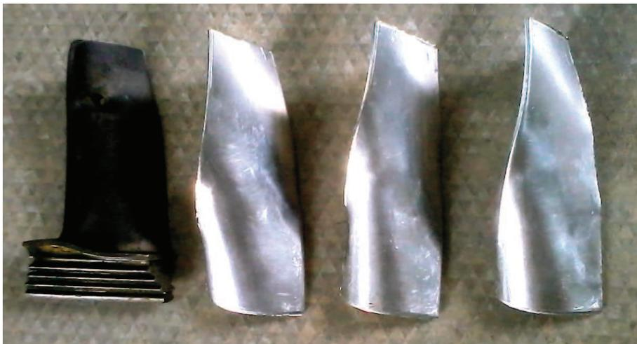
Figura 4.7: Recreación del Álabe de Turbocargador ABB.
