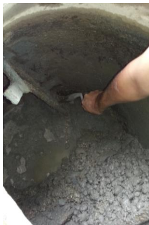
Figura 6.8: Proceso de defloculación y dispersión de las partículas de cemento (Formación de bolas).
