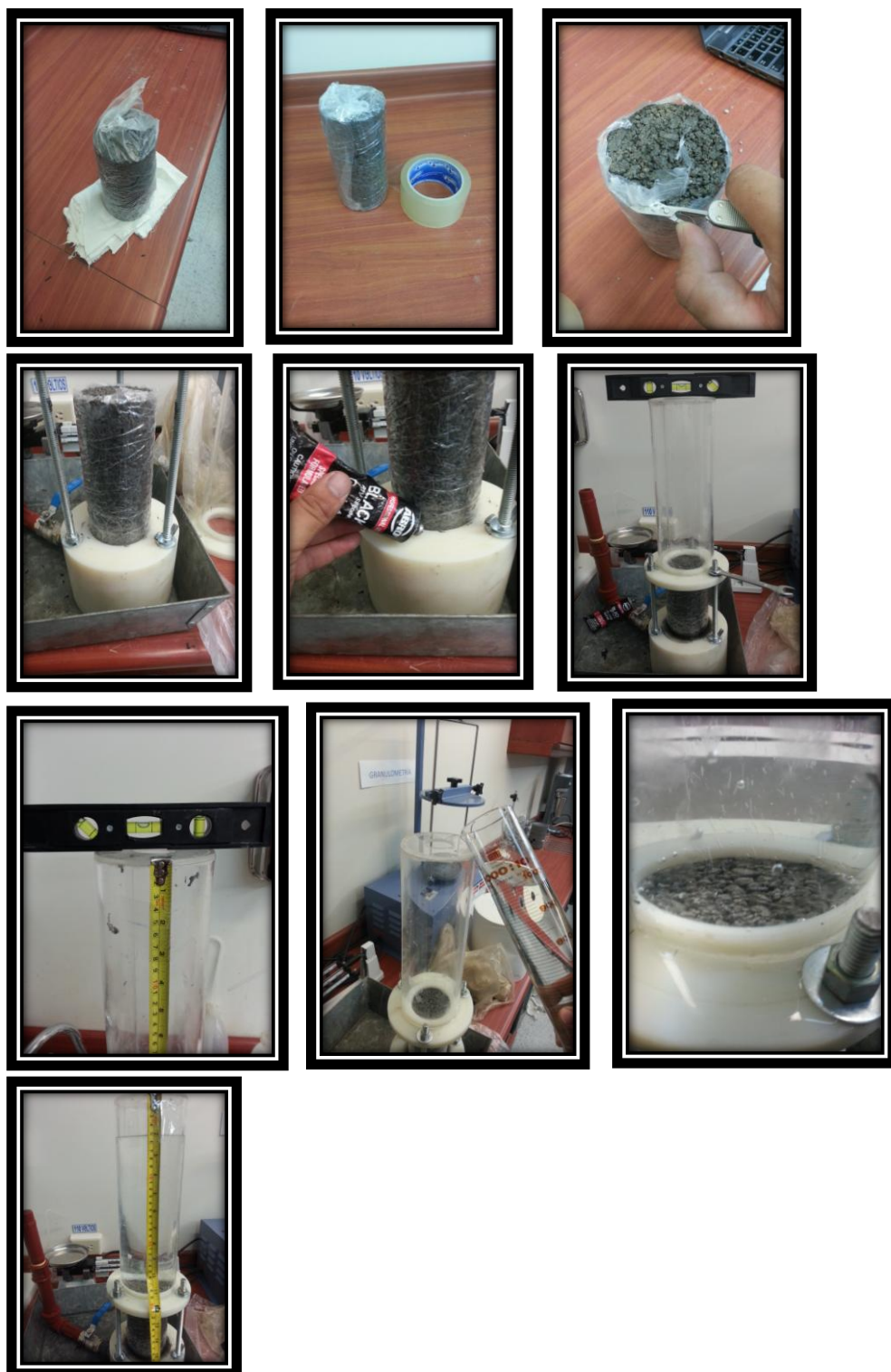
Figura 7.4: secuencia que describe gráficamente el proceso de preparación de las muestras para el análisis de permeabilidad.
