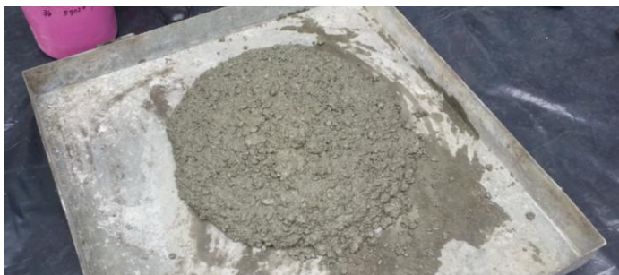
Figura 6.9: Mezcla una vez cumplida la reacción del superplastificante.
