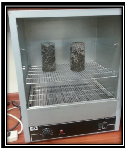
Figura 7.2: Cilindros Beta 1 puestos a secar.
