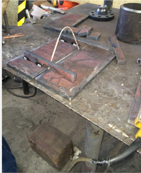
Fig.3.2. Probeta armada para realizar el cordón de soldadura
