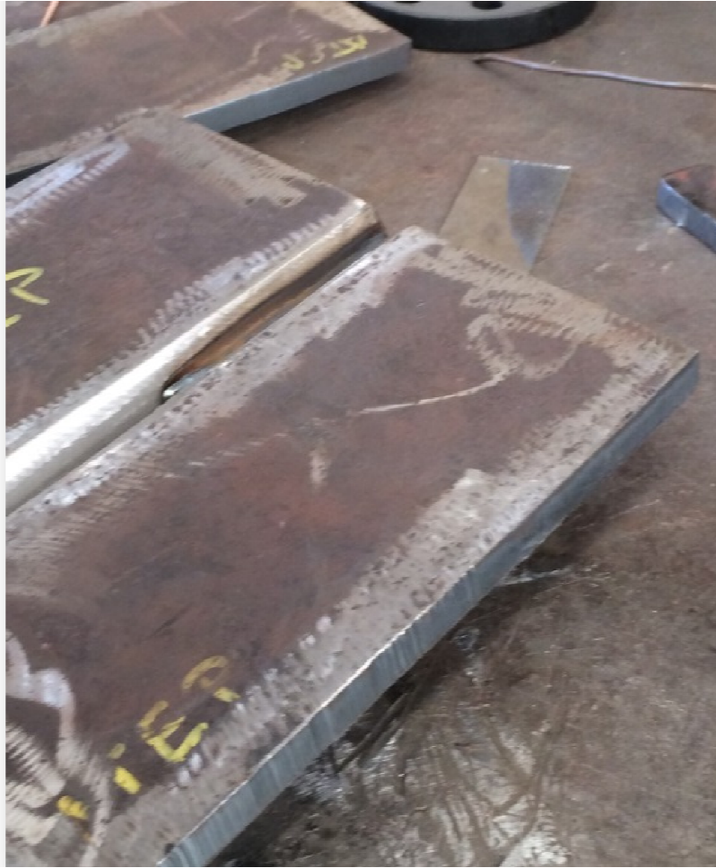
Fig.3.3. Pase de raíz, vista superior
