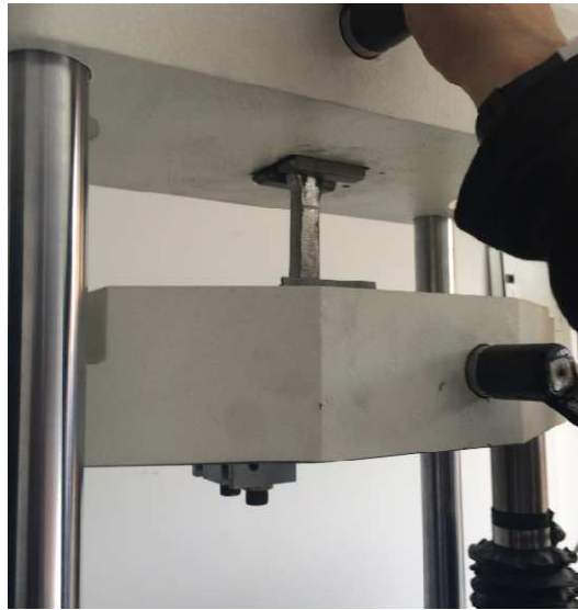
Fig.3.21. Probetas sujetadas en la máquina de ensayos de tracción de probetas sin soldadura
