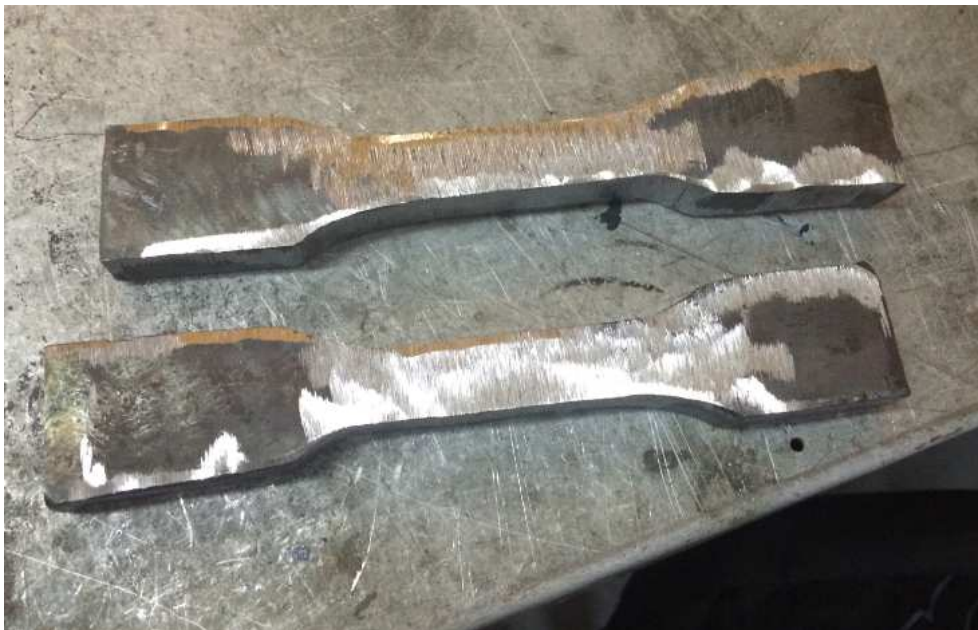
Fig.3.20. Probetas sin soldadura para ensayos de tracción
