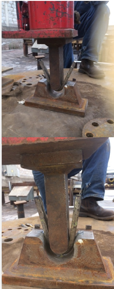
Fig.3.14. Desarrollo de la prueba de doblado
