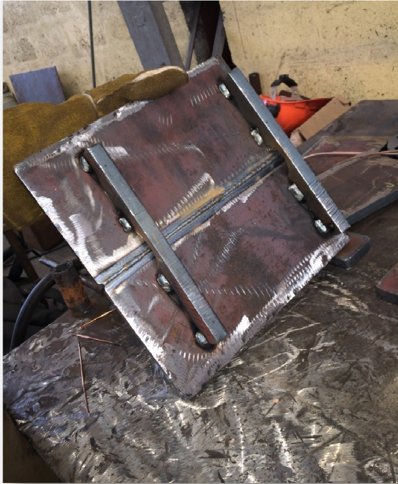
Fig.3.4. Pase de raíz, vista inferior
