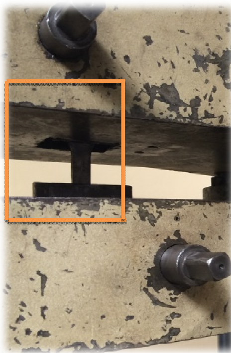
Fig.3.18. Probeta sujeta en la máquina para realizar ensayos de tensión
