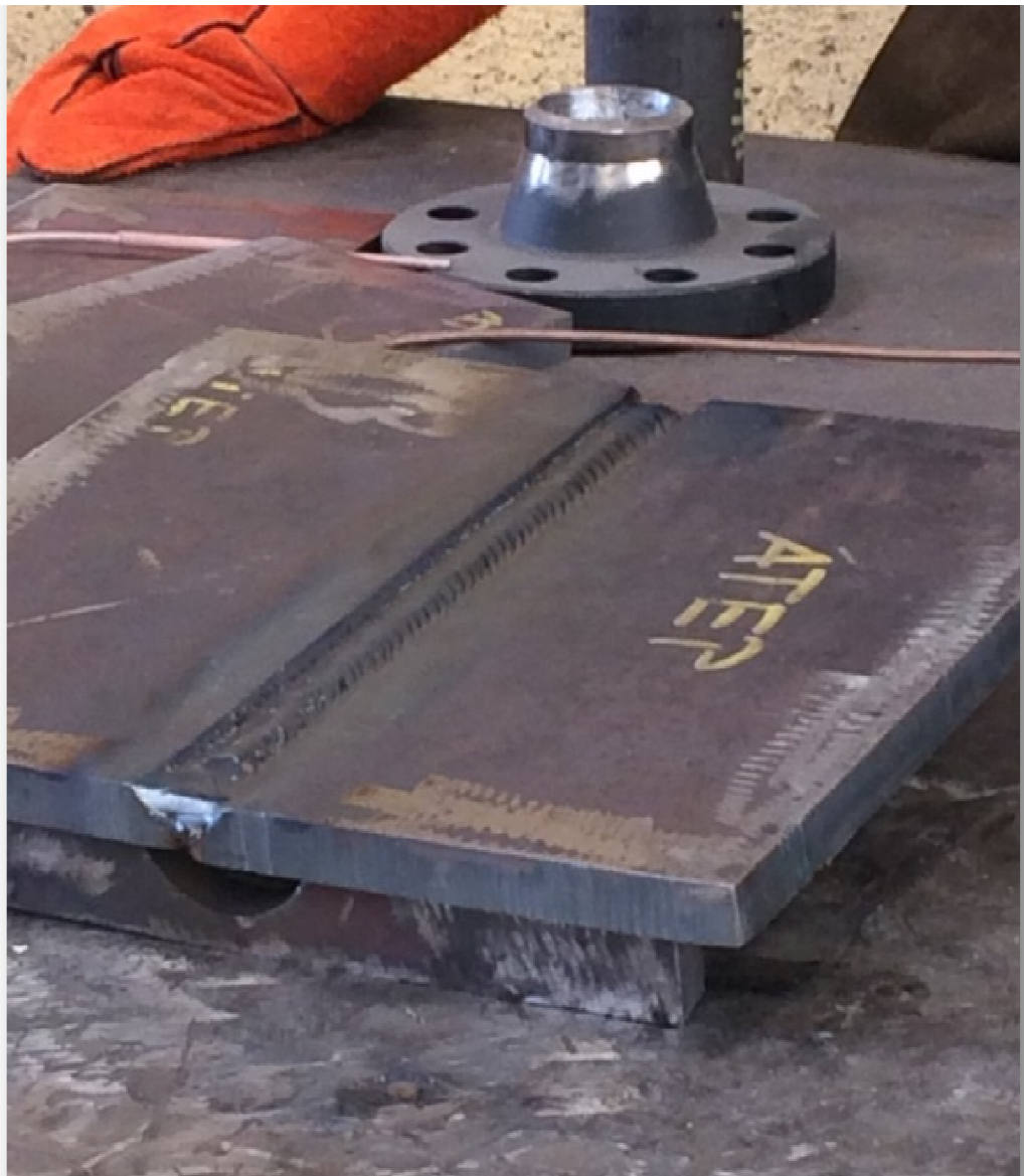
Fig.3.6. Pase de relleno con movimiento en sig-sag 2 y 3
