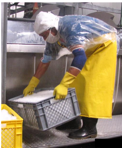
Figura 46. Adición manual de hielo a chillers de enfriamiento. Fuente: Planta Procesadora Avícola VITALOA SA, fotografiado por Pérez E, 2012.
