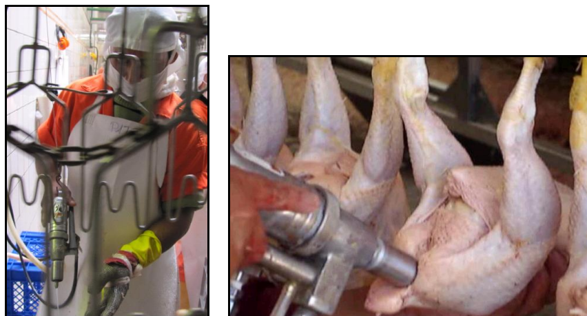
Figura 8. Extractor de cloacas, pistola neumática de extracción Fuente: Eviscerado Planta Procesadora Avícola AVITALSA SA, fotografiado por Pérez E, 2012.
