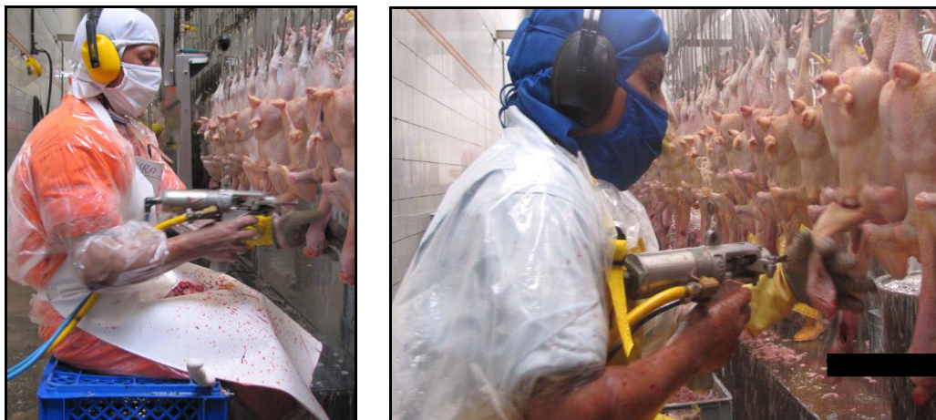
Figura 10. Corte de cuello con tijera neumática
