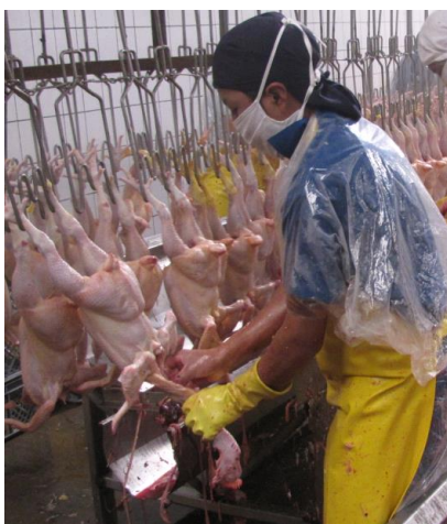
Figura 44. Extractor de cuellos (Planta Procesadora Avícola VITALOA SA, fotografiado por Pérez E, 2012).
