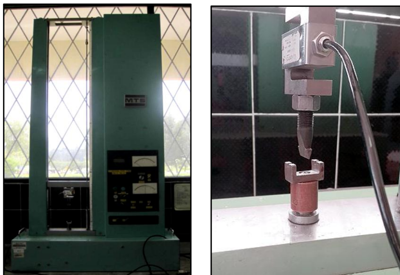
Figura N° 18. Máquina de ensayos universales MTS Modelo 5000.
