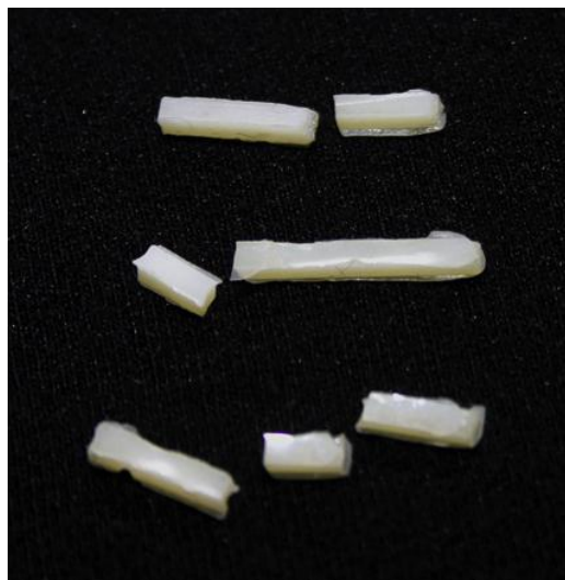
Figura N° 8. Bloques de resina fracturados excluidos de la prueba de flexión
