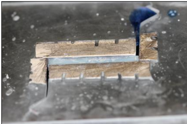
Figura N° 9. Resina compuesta sin precalentar colocada en las matrices metálicas con incrementos de resina de 1mm de espesor.
