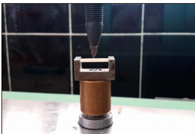
Figura N° 19. Bloque de resina colocado en dispositivo para prueba de flexión.
