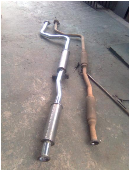
Gráfico 3 Tuberías de Escape
