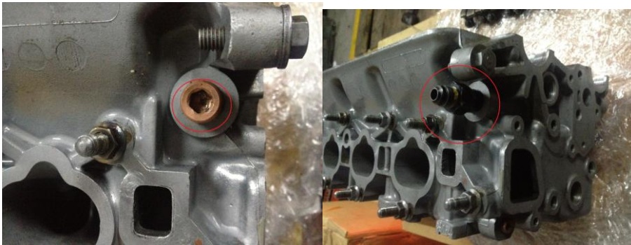
Gráfico 47 Colocación acople línea de aceite
