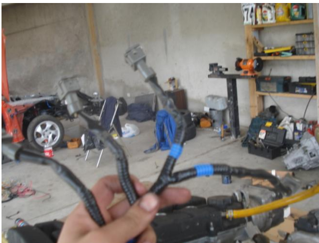
Gráfico 76 Ramal desarmado para re direccionar cables
