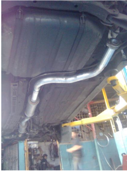
Gráfico 4 Tubería de escape colocada
