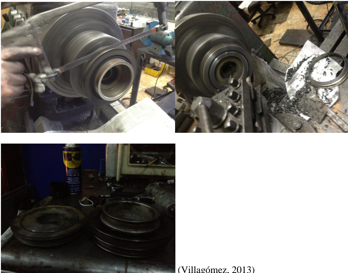
Gráfico 74 Secuencia fotos polea banda de servicios
