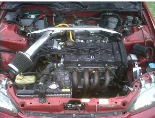
Gráfico 38 Cambio de motor B18B3
