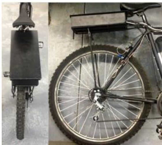
Figura 12 Parrilla y caja metálica para controlador.
