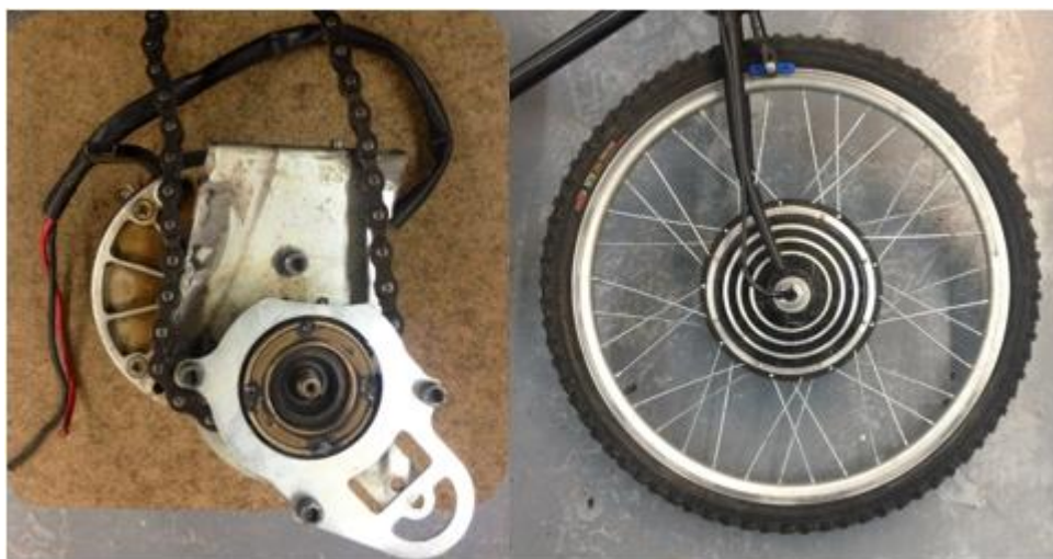
Figura 10 Izquierda motor brushed y derecha motor brushless
