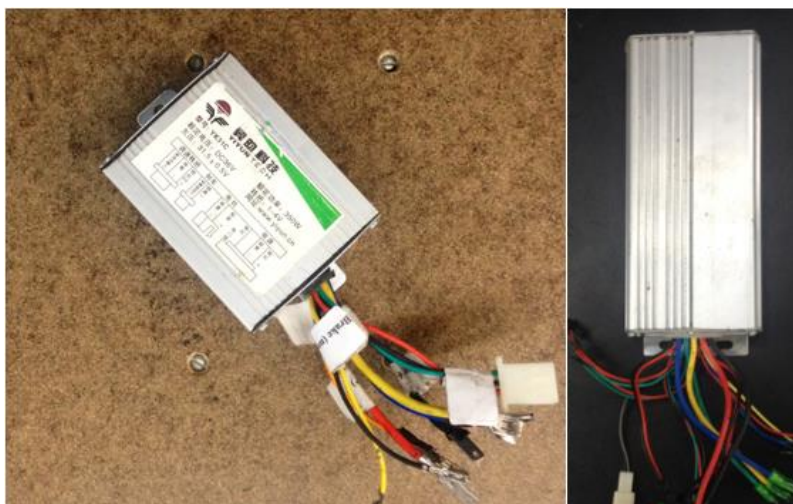
Figura 16 Derecha controlador brushed e izquierda controlador brushless
