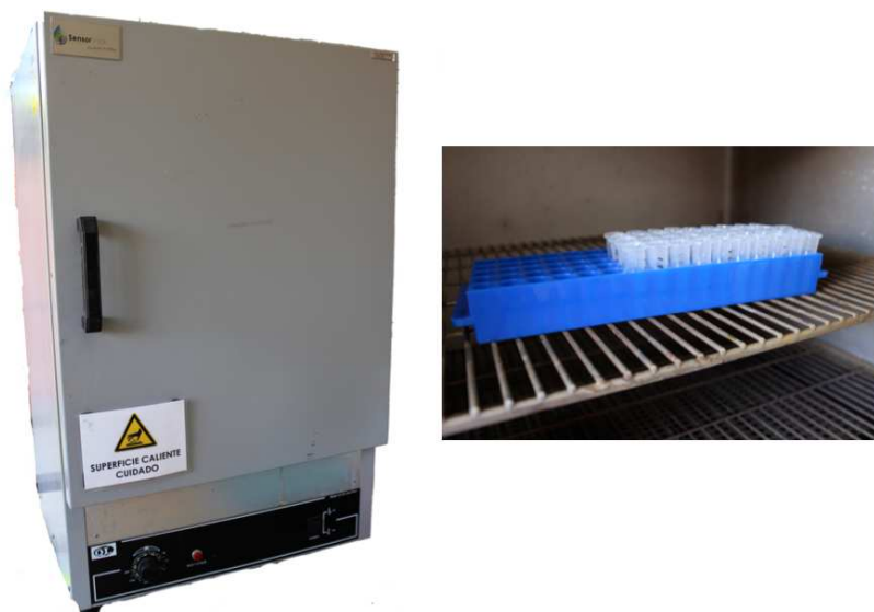
Figura 49 Estufa de calor seco - Almacenamiento 12 h a 105°C
