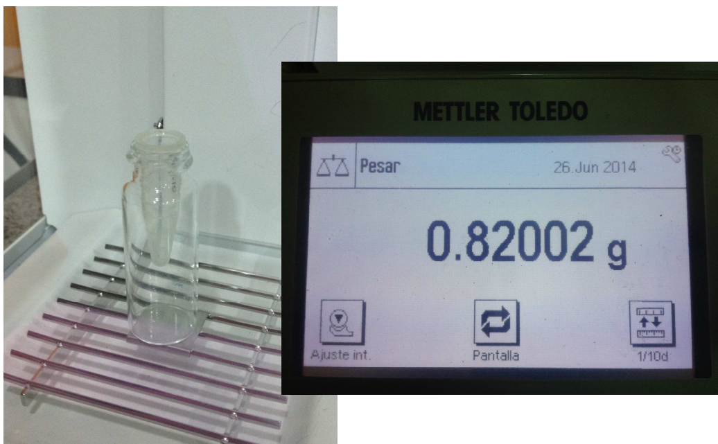
FIGURA 52 PESAJE Y REGISTRO EN MG DE DEBRIS EXTRUIDOS
