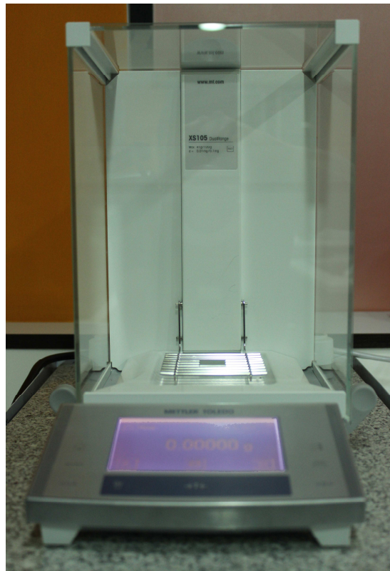
Figura 51 Balanza Analítica 0,01 mg de precisión
