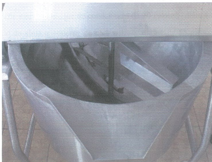
Figura 4.3 : Foto de un agitador de ancla y raspadores de teflón en la marmita (Anexo 15)
