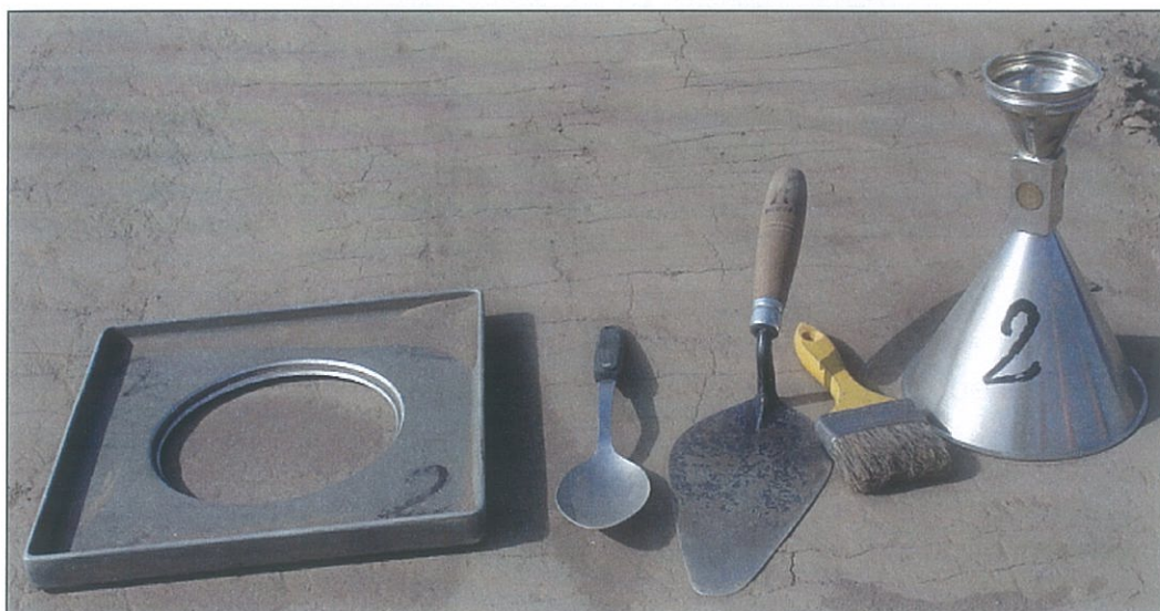
Figura 3.1.- Cono doble con válvula, base metálica y otros implementos para el ensayo.
