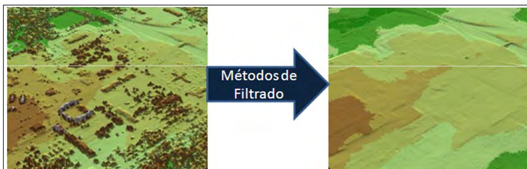
Figura 2-10: MDT resultado del filtrado de los datos crudos del MDS
