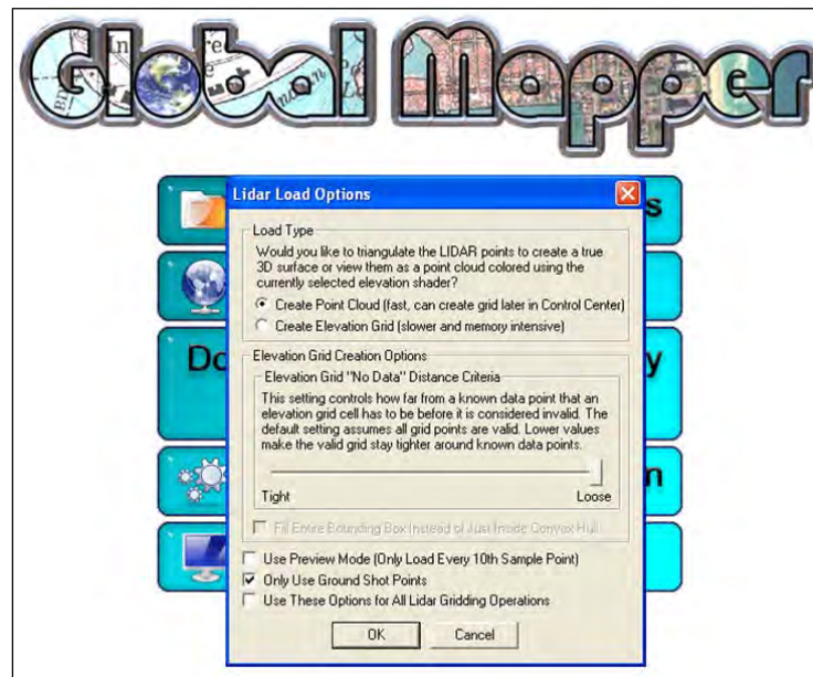
Figura 3-7: Filtrado de puntos clasificados al terreno LAS – Global Mapper 11
