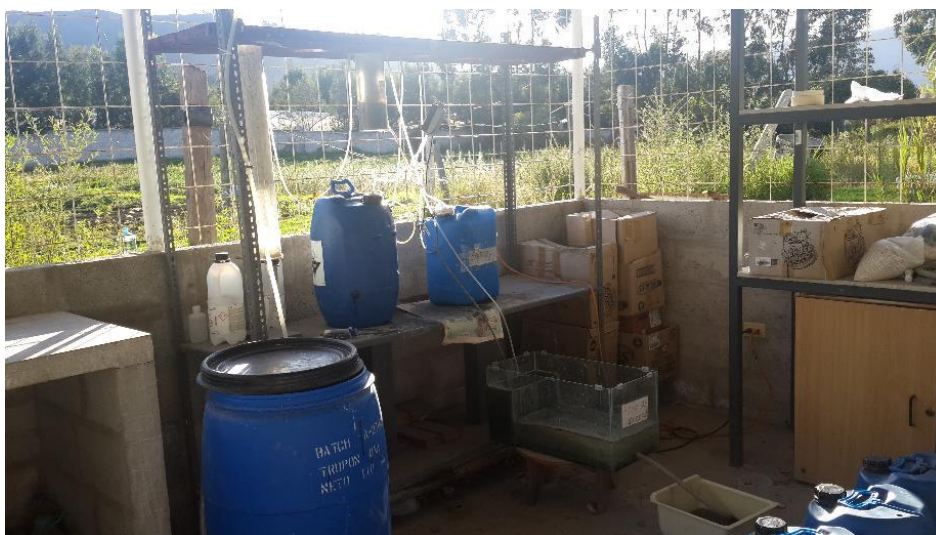
Fotografía 2. Planta de Tratamiento de Agua Residual a escala piloto con un tratamiento de mezcla controlada y lechada de cal, diseñado por Valdés y Peñafiel. Tomada por Ana Belén Bruzual.
