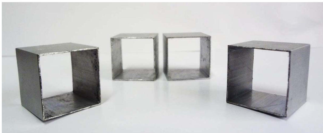
Fotografía No. 13.- Moldes de aluminio en forma cuadrada de 3 cm x 3 cm y 1,5 cm de espesor, para la elaboración de cubos de acrílico que portaban los especímenes dentales.
