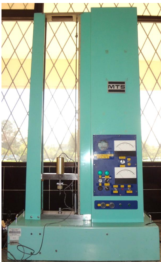
Fotografía No. 31.- Máquina de Ensayos Universales, modelo T 5002 (MTS), encargada de ejercer fuerzas de cizallamiento sobre las muestras.
