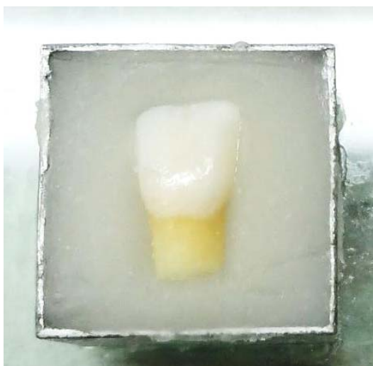
Fotografía No. 15.- Diente de bovino colocado sobre molde de aluminio con acrílico, con la superficie vestibular hacia el ambiente externo.
