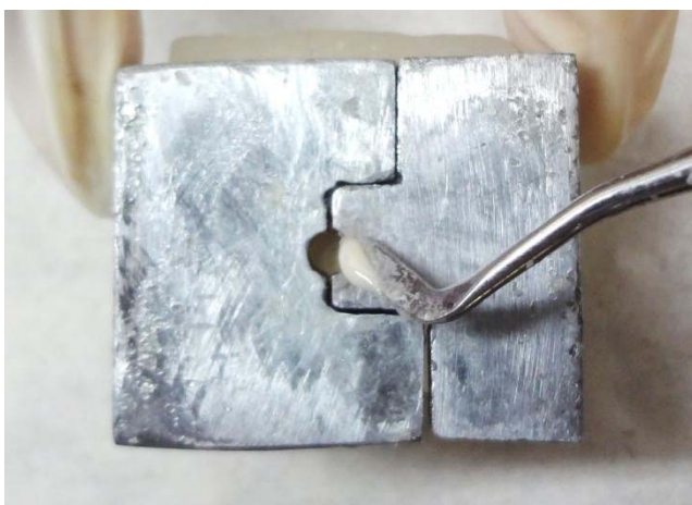
Fotografía No. 26.- Colocación de IVMR por el agujero de la matriz metálica, utilizando un gutaperchero metálico.
