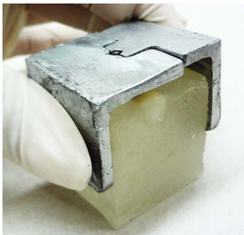
Fotografía No. 19.- Matriz metálica sobre la muestra. Se observan aristas de seguridad hacia los extremos para proporcionar estabilidad y deslizamiento de la matriz.
