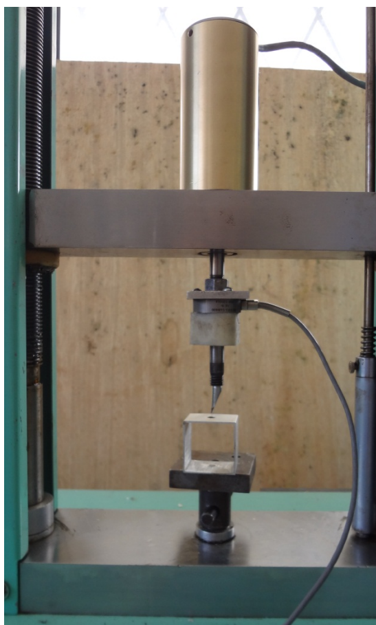
Fotografía No. 32.- Acercamiento de la Máquina de Ensayos Universales. Se observa dispositivo metálico cuadrado para sujetar la muestra y la barra metálica, encargada de ejercer las fuerzas de cizallamiento a una velocidad de 0,5 a 0,8 mm/min.
