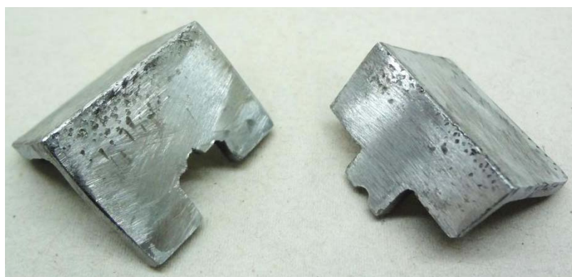
Fotografía No. 18.- Matriz metálica separada en sus dos estructuras.
