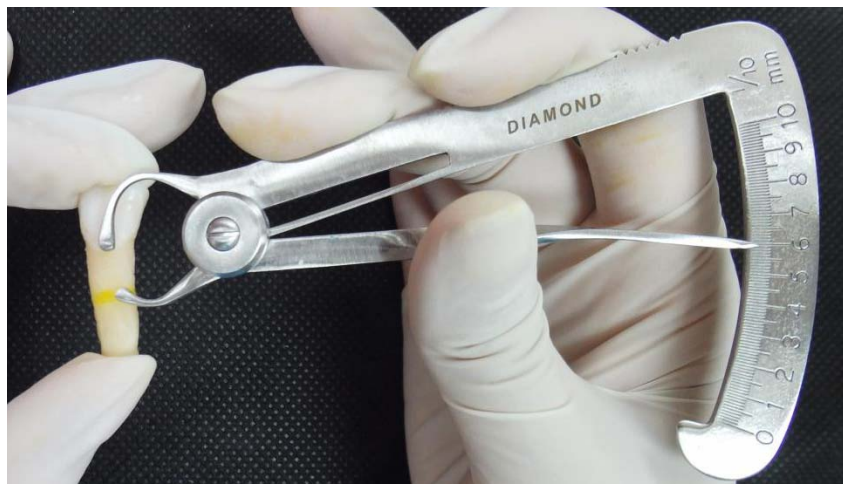
Fotografía No. 7.- Medición de la línea de corte de un diente de bovino utilizando un calibrador de metal.
