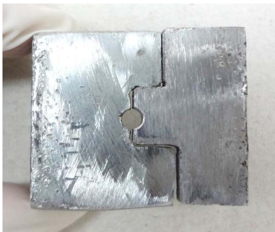
Fotografía No. 17.- Matriz metálica de 3 cm x 3 cm y 3 mm de espesor, con agujero en posición central de 3 mm de diámetro y 3 mm de profundidad.
