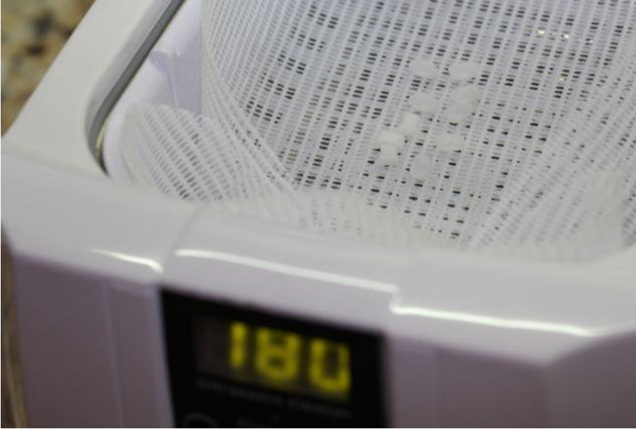
Figura 33 Limpieza ultrasónica de las cofias
