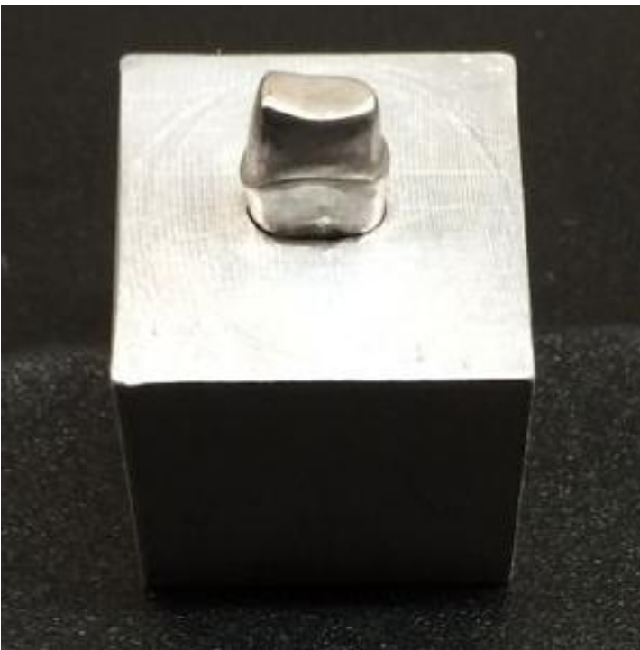
Figura 6 Vista de preparación en muñón de cromo-cobalto
