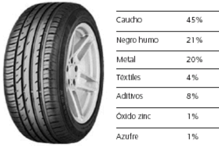
Grafico 5: Composición del Neumático
