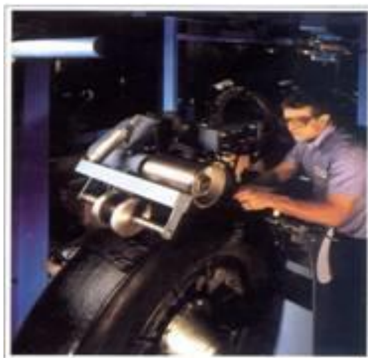
Imagen 4: Colocación de la banda de rodamiento nueva
