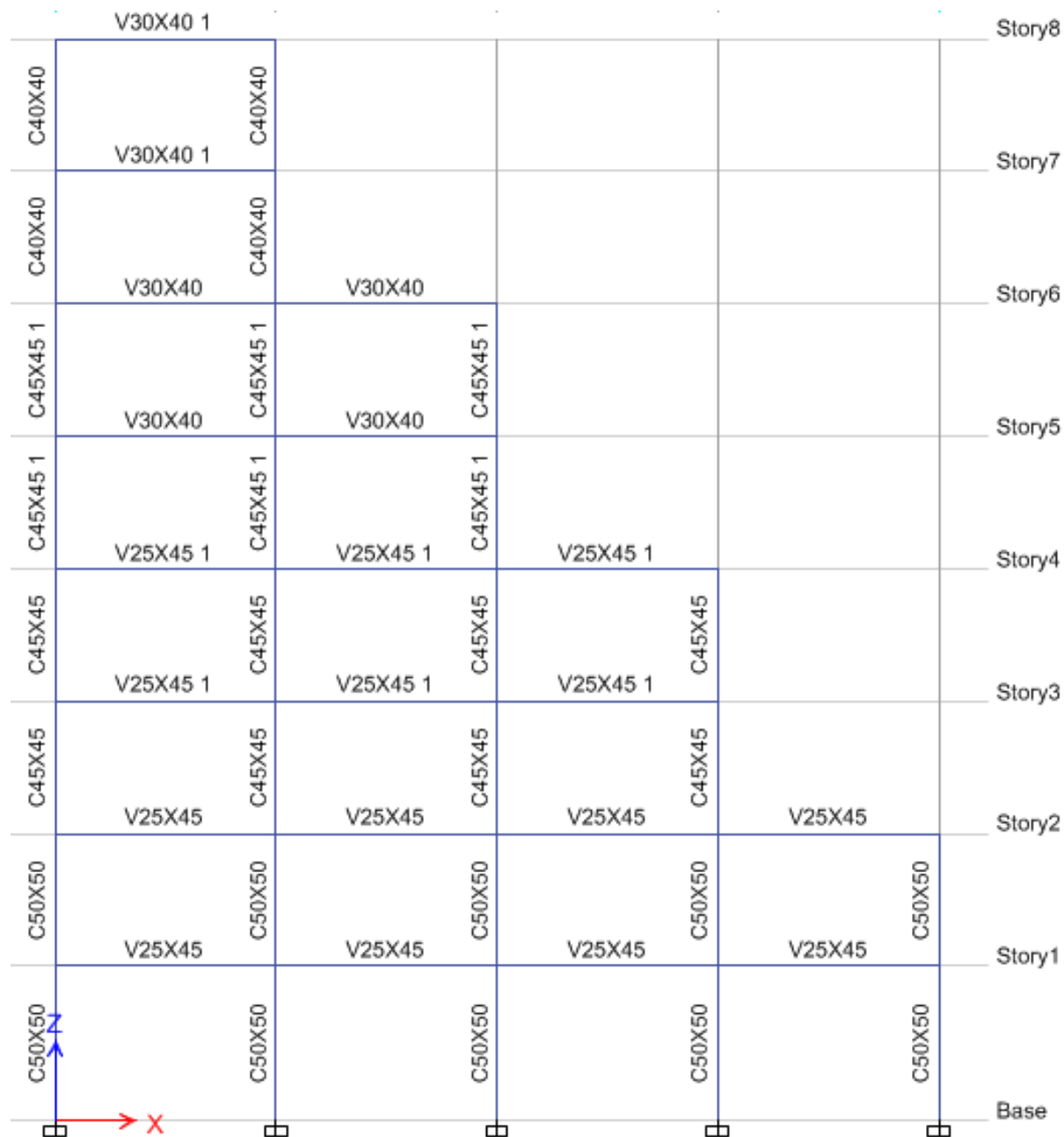
Figura 25. Secciones edificio irregular 8 pisos, DBF.
