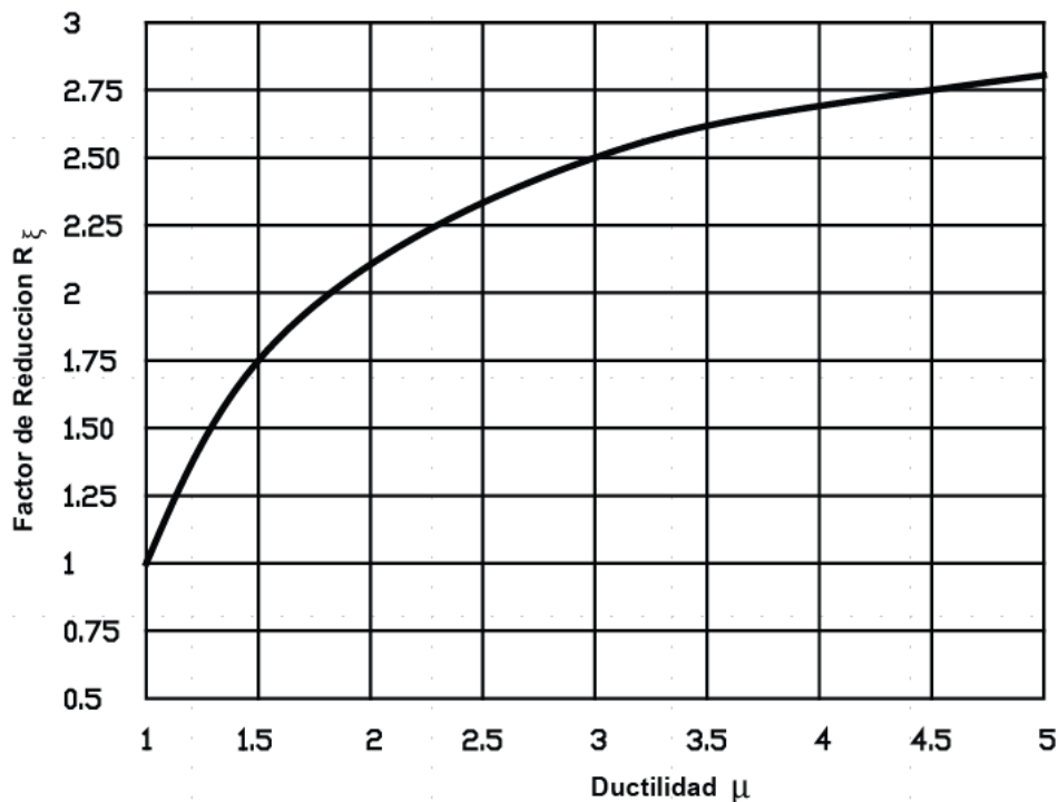
Figura 7. Factor de reducción de la demanda sísmica (Priestley et. Al., 2007)
