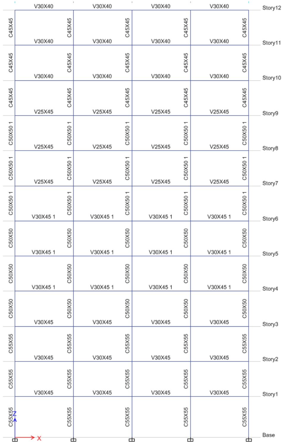
Figura 15. Secciones edificio regular 12 pisos, DBF.
