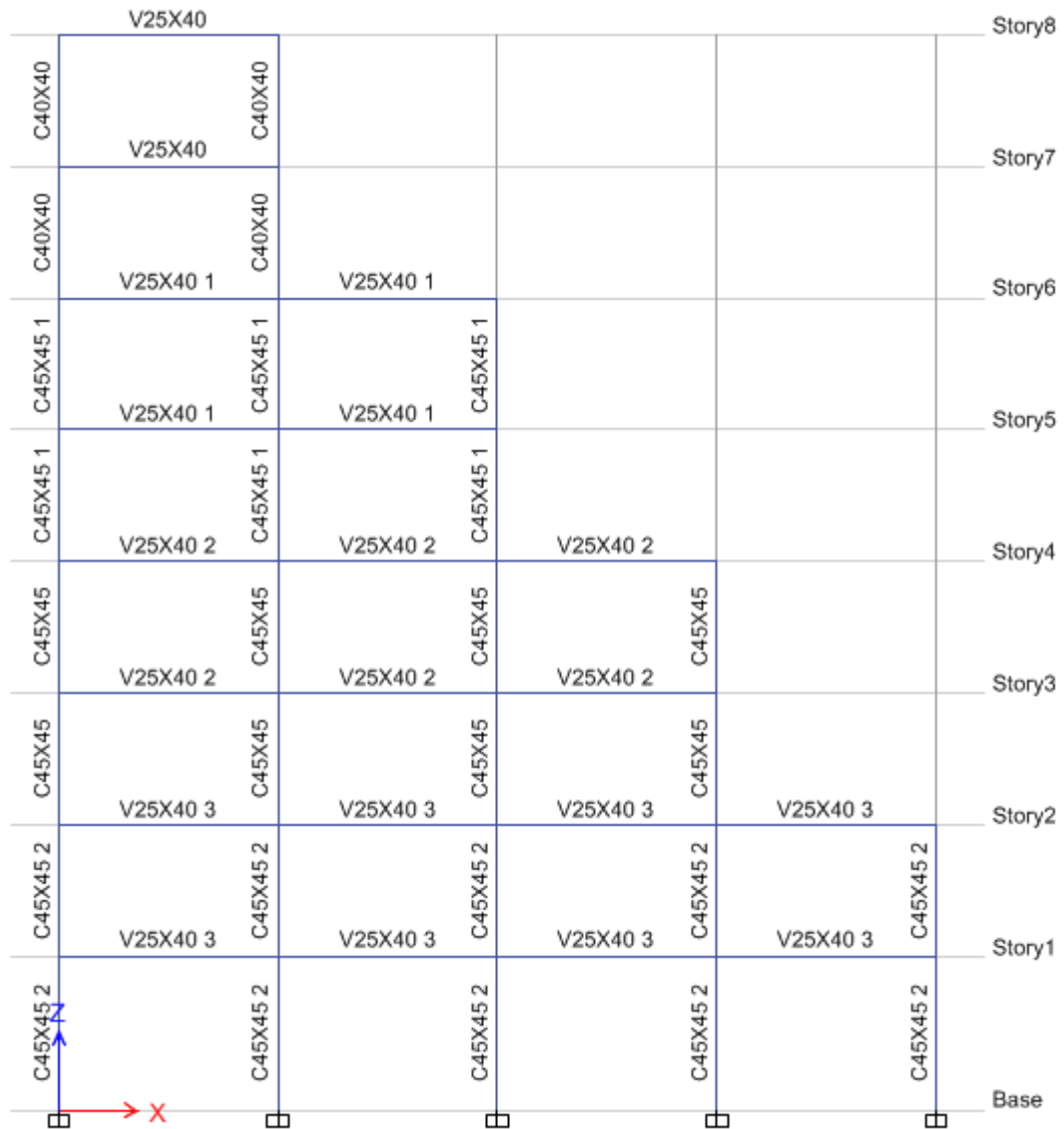
Figura 28. Secciones edificio irregular 8 pisos, DDBD.
