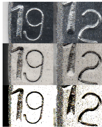
Figura 9: Depósito nodular sobre las probetas #12 y #19. Se aplica degradado gráfico de color base (hacia abajo) para una mejor observación de la cantidad de depósitos nodulares sobre la superficie.
