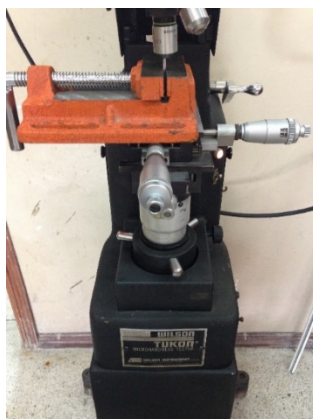
Figura 5: Fotografía de Micro durómetro marca Wilson Tukon.
