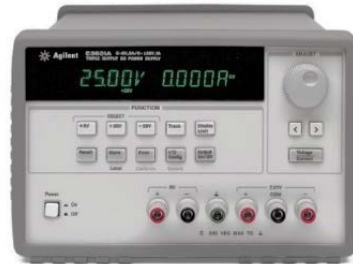
Figura 3: Imagen de fuente de poder marca Agilent modelo E3631A.
