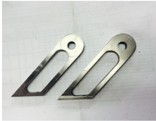
Ilustración 61. Pieza maquinada Apoyo Externo (Fuente: Elaboración propia)
