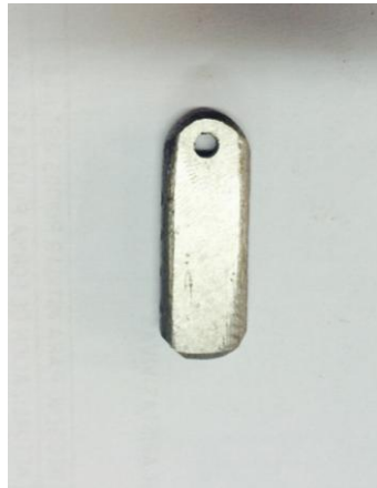
Ilustración 65. Pieza maquinada Seguro Resorte (Fuente: Elaboración propia)
