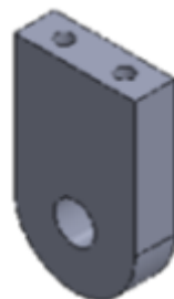
Ilustración 43. Render USFQ-001-04 Apoyo Carga Eje
