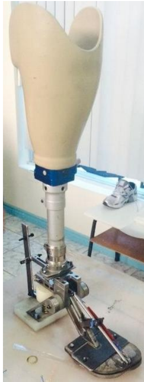
Ilustración 75. Prótesis con el mecanismo de tesis ensamblada en su totalidad (PH. Uquillas)
