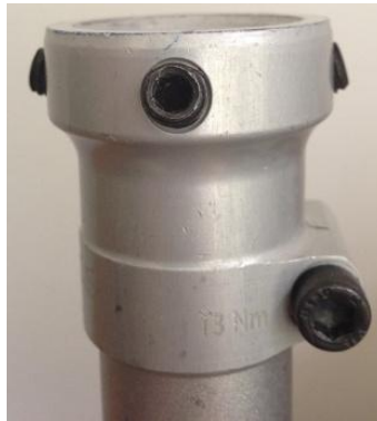
Ilustración 74. Unión universal modular tipo pirámide para exoprótesis de miembro inferior (PH. Uquillas)
