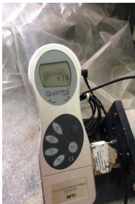
Figura 59 Registro de valores - indicador de fuerza y torsión Quantrol Dillon
