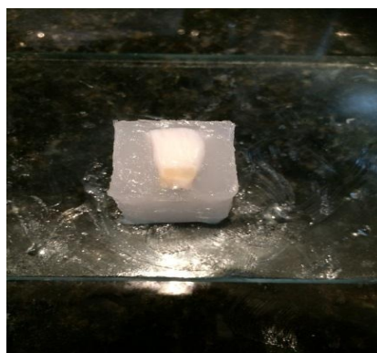
Figura 38 Remoción del cubo metálico después de la polimerización acrílica
