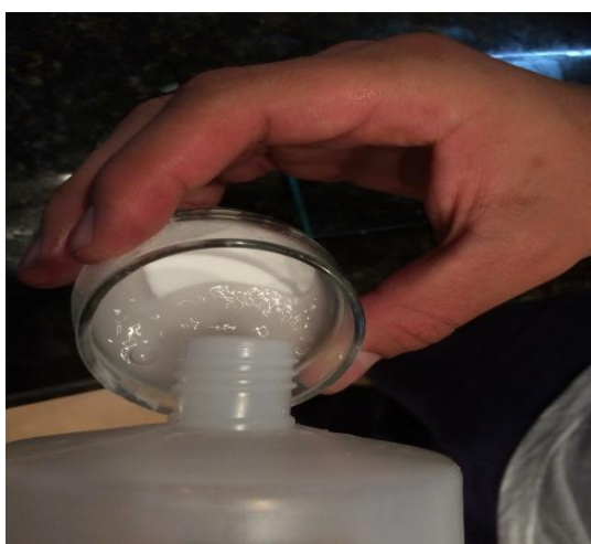
Figura 33 Colocación de monómero acrílico
