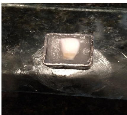
Figura 37 Inserción del espécimen en el acrílico, dejando expuesta la zona a restaurar
