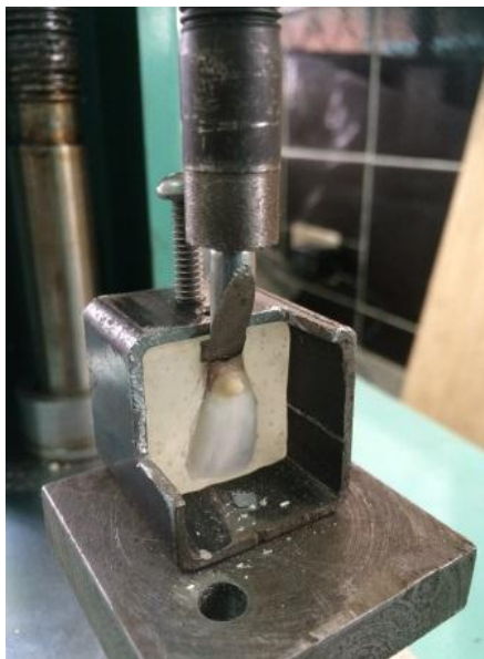
Figura 58 Máquina JJ machine type 5002 - aplicación de fuerza de cizallamiento
