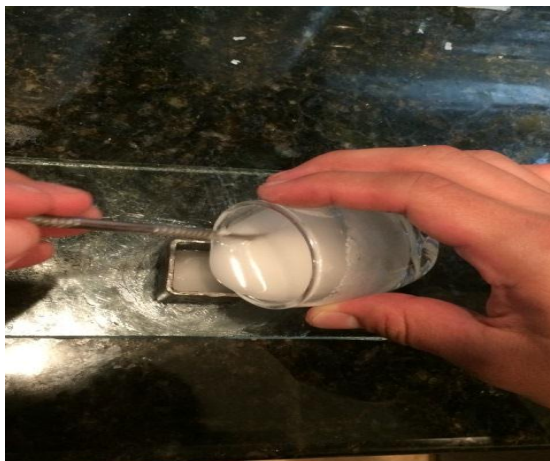
Figura 36 Colocación del acrílico en los cubos metálicos
